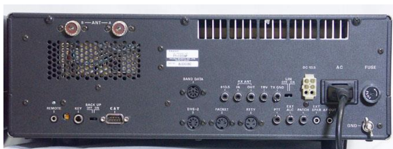
Slika 1.2. Stražnja ploča radiouređaja YAESU FT-1000MP [4]
