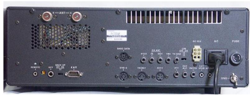
Slika 1.2. Stražnja ploča radiouređaja YAESU FT-1000MP [4]
