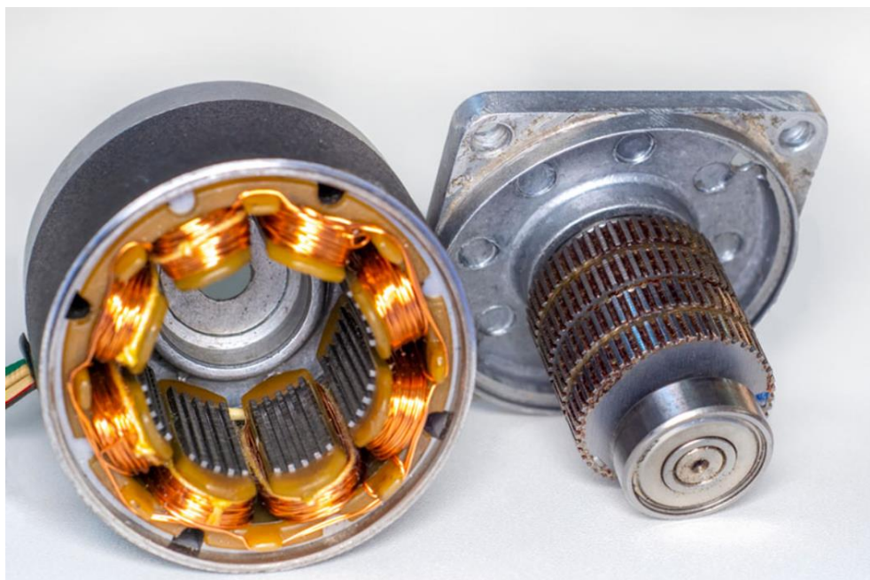
Slika 8.2. Rotor zubčanika okružen magnetskim zavojnicama/ Koračni motor [12]
