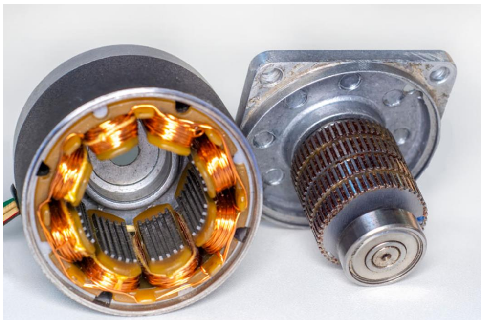
Slika 8.2. Rotor zubčanika okružen magnetskim zavojnicama/ Koračni motor [12]
