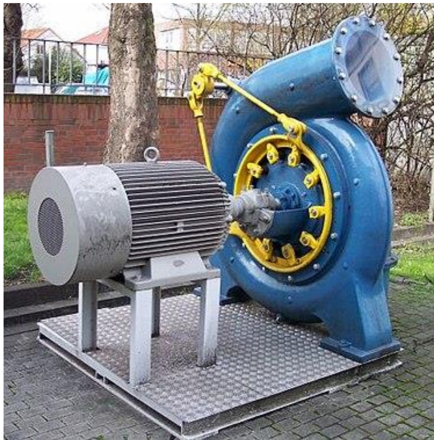
Slika 3.6. Mala Francisova turbina spojena na generator [30]
