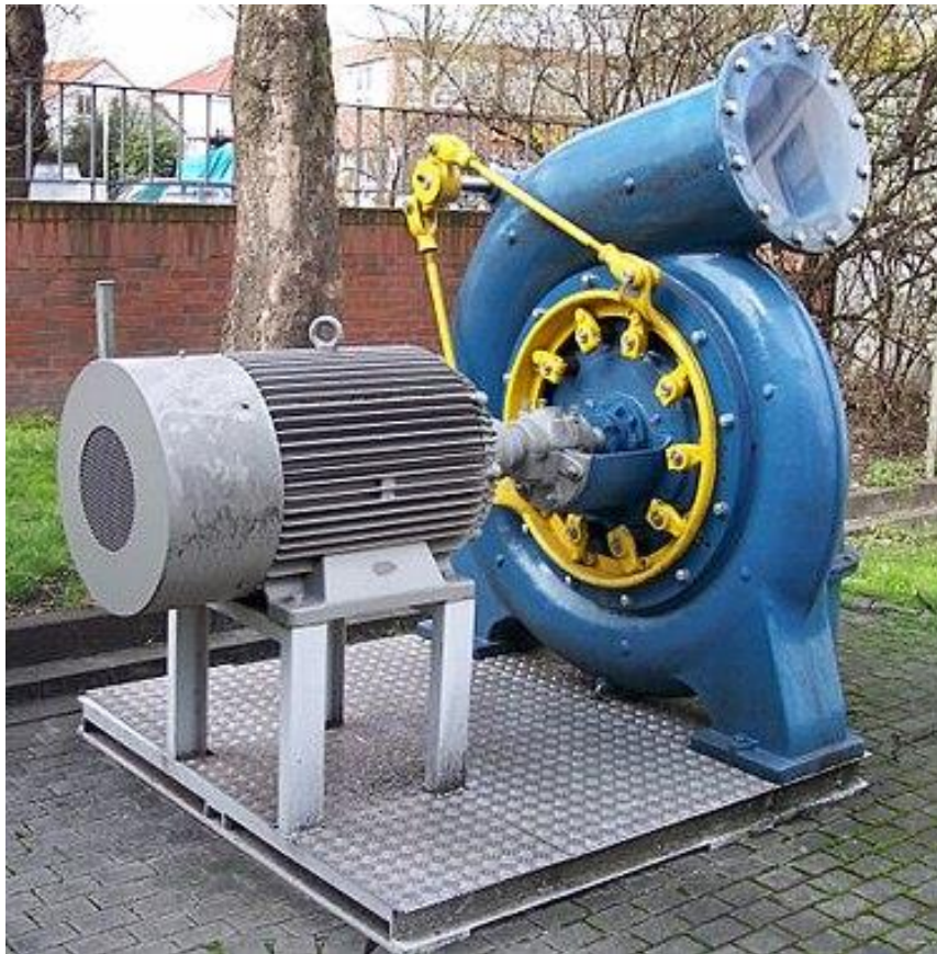
Slika 3.6. Mala Francisova turbina spojena na generator [30]
