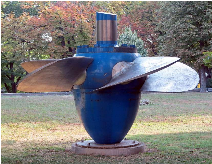
Slika 5.4. Kaplanova turbina (preuzeto sa: https://www.wikidata.org/wiki/Q213947 )
