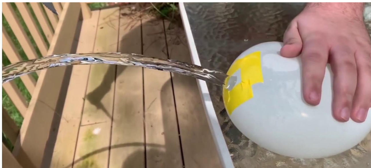
Slika 3.3. Laminarno strujanje (preuzeto sa [27])
