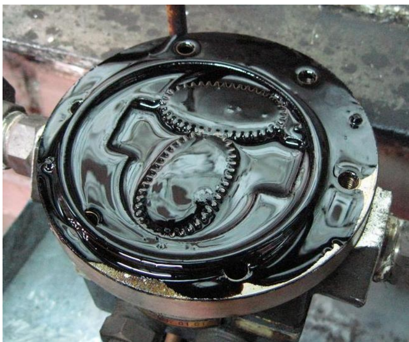
Slika 4.2. Položaj zupčanika unutar kućišta protokomjera s ovalnim zupčanicima (preuzeto sa [34])
