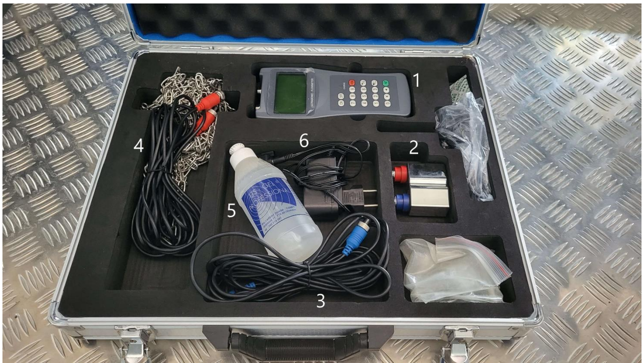
Slika 5.4. Set pribora ultrazvučnog protokomjera FDT-21 (izvor: autor)
