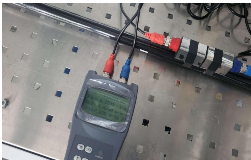
Slika 7.4. Ispravno postavljeni pretvarači na cijev (izvor: autor)
