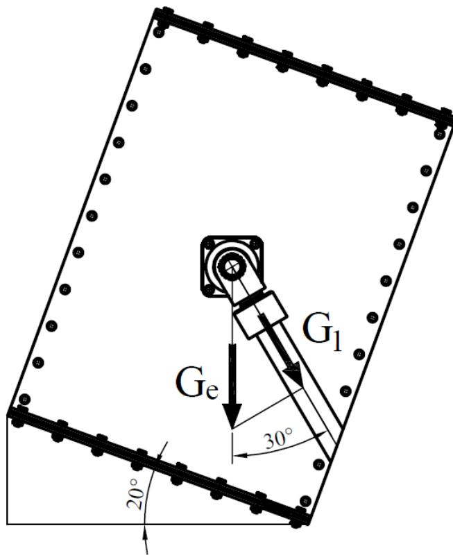
Slika 8.1. Sila težine elevatorsa i sila koja djeluje na hidrauličke cilindre
