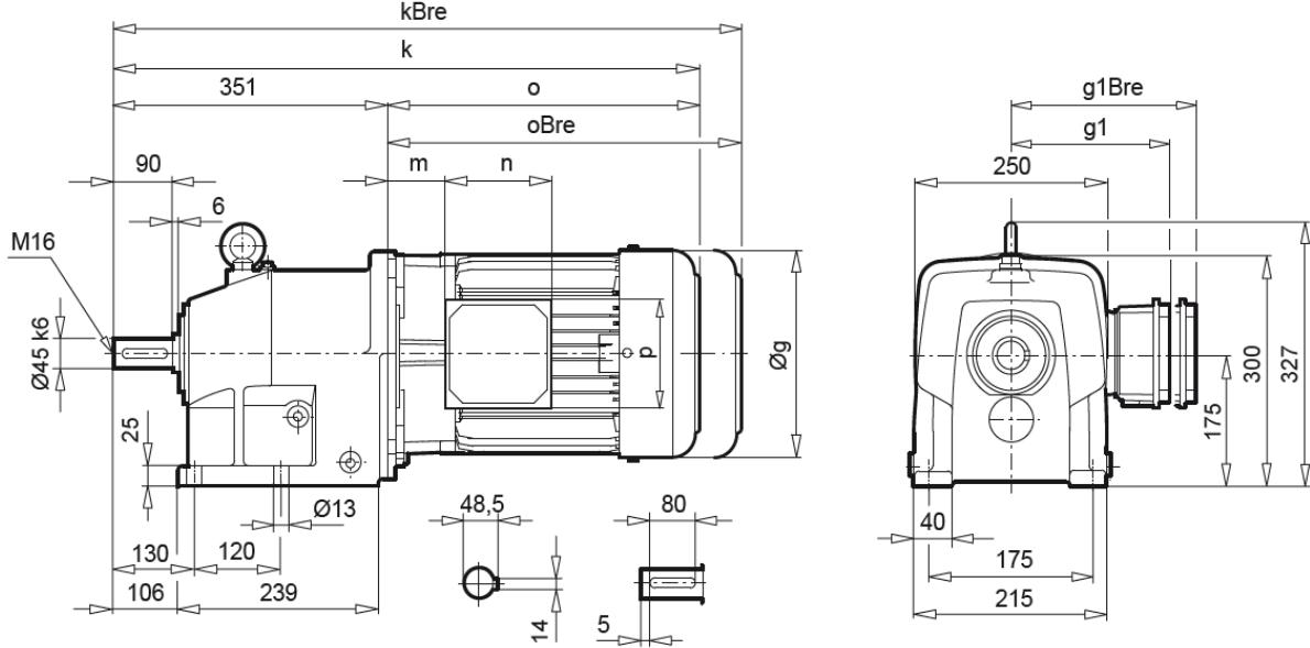
Slika 7.1 . Izgled elektromotora SK 42-132 SP/4 s označenim dimenzijama [11]
