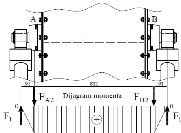
Spoj hidrauličkih cilindara s gornjom osovinom.
