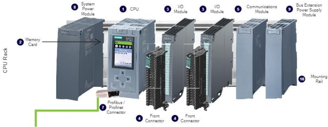
Slika 1 Komponente modularnog PLC-a [3]
