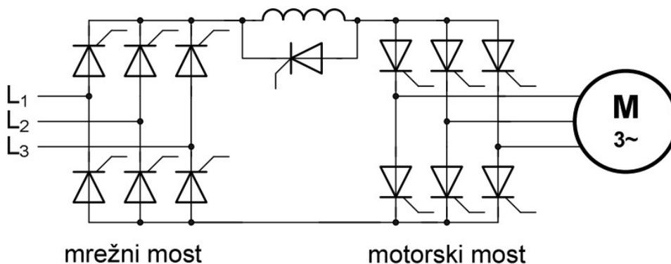
Slika 4.3 Shema sinkrokonvertera [12]
