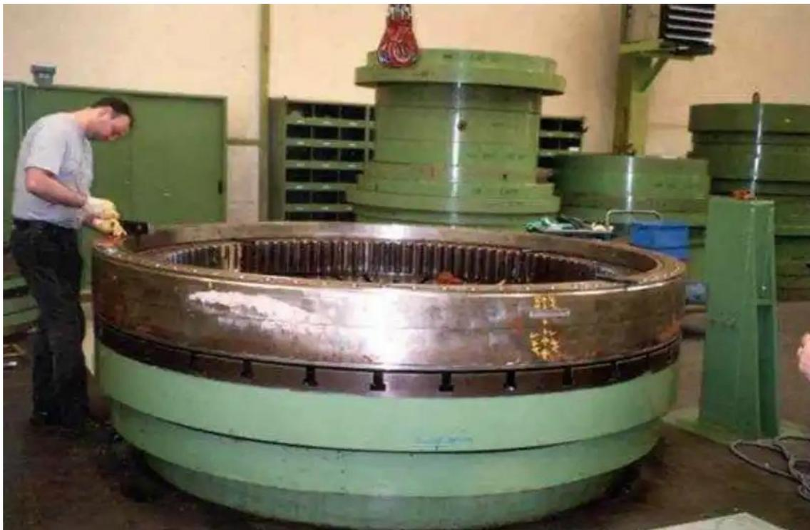
Slika 2.3. Upravljački prsten za azipod od 7.5 MW [4]
