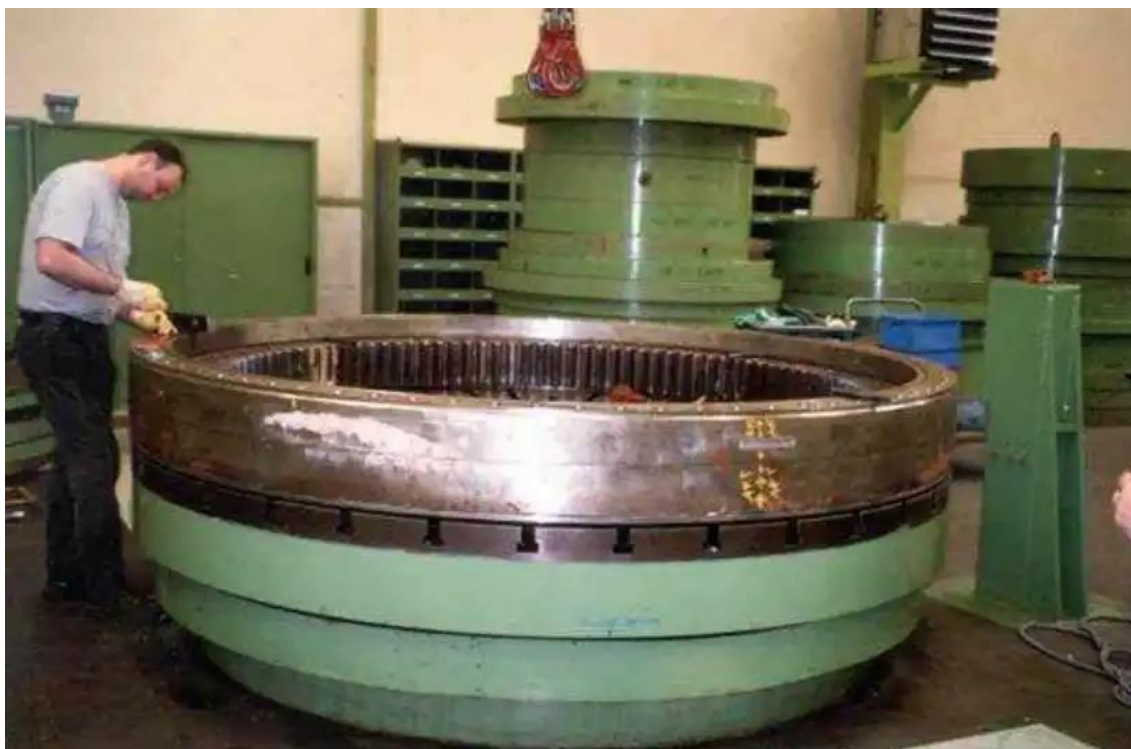
Slika 2.3. Upravljački prsten za azipod od 7.5 MW [4]
