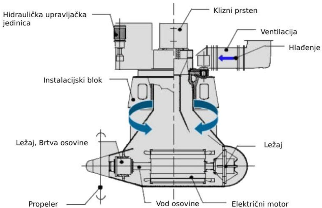
Slika 2.1.1 Kućište azipoda [4]
