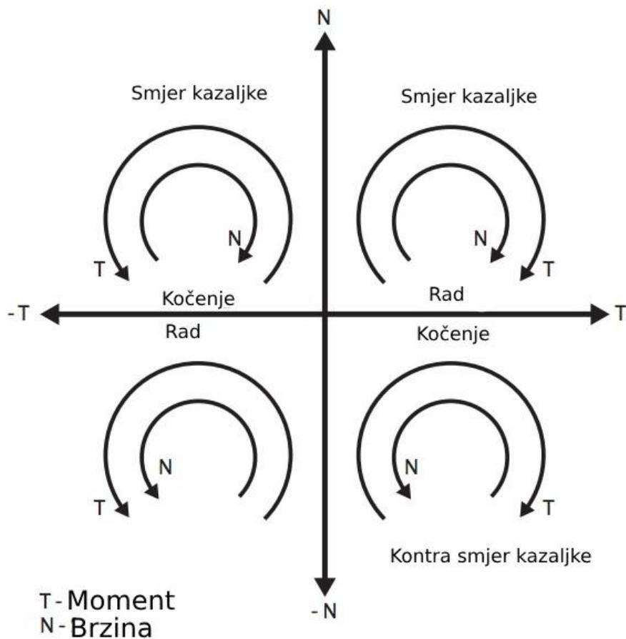
Slika 4.2 Princip rada u četiri kvadranta [11]
