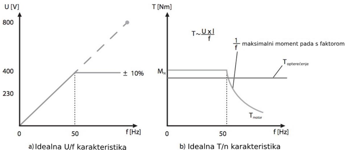
Slika 4.1 Princip rada U/f karakteristike i momenta [11]
