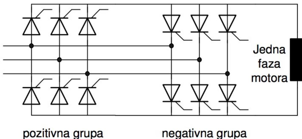
Slika 4.4 Shema ciklokonvertera [12]
