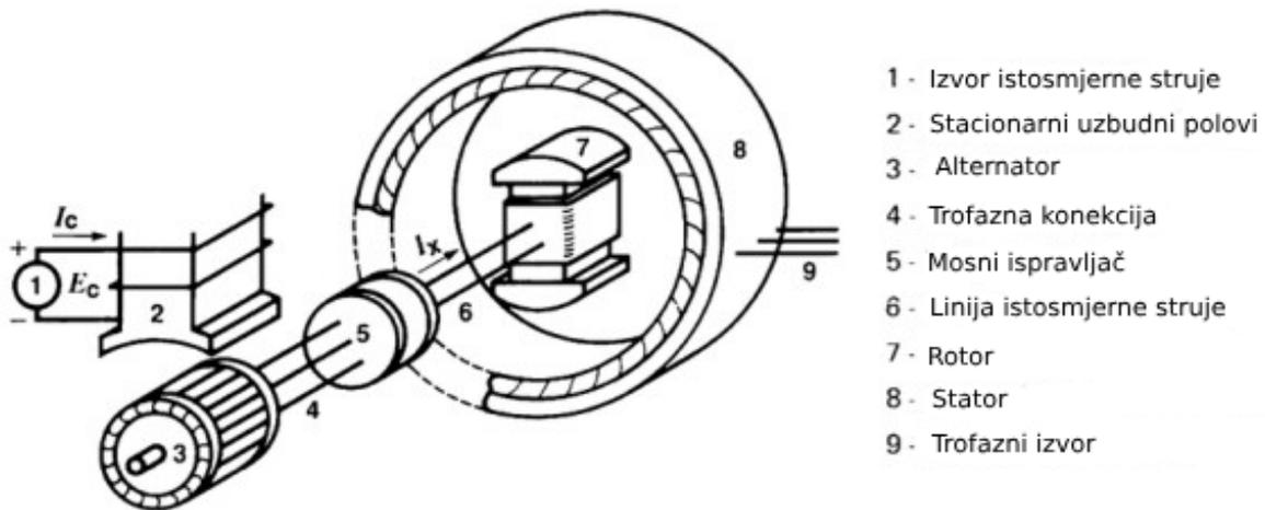
Slika 3.2.1 Shema trofaznog sinkronog motora [9]
