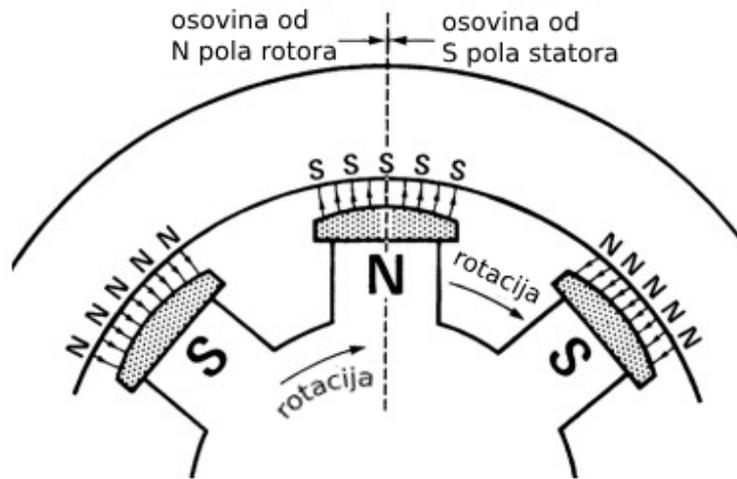
Slika 3.2.2 Polovi statora i rotora sinkronog motora [9]
