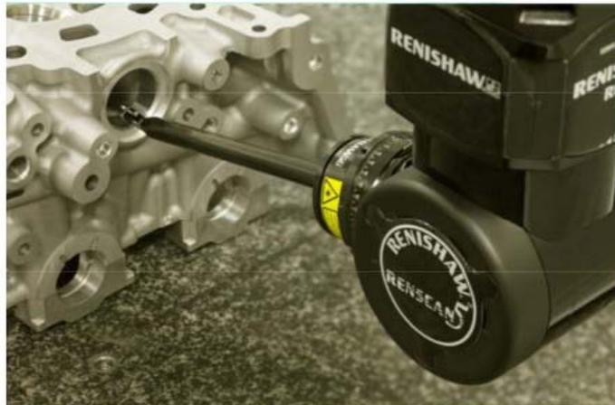
*Slika 4.5 Senzor na vrhu mehaničke ruke*
