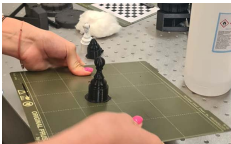
Slika 6.13 Postupak savijanja podloge za uklanjanje artefakta
