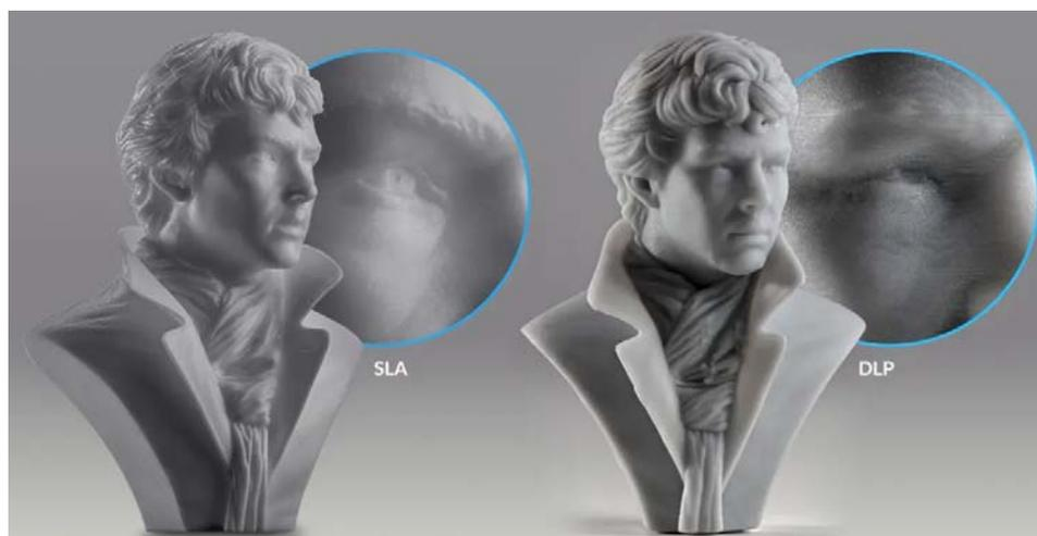
*Slika 2.13 SLA i DLP kvaliteta površine*
