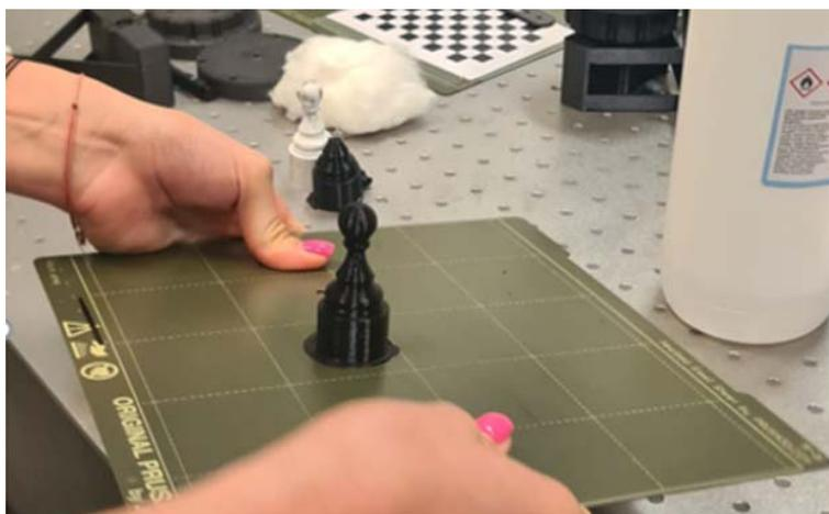
*Slika 6.13 Postupak savijanja podloge za uklanjanje artefakta*
