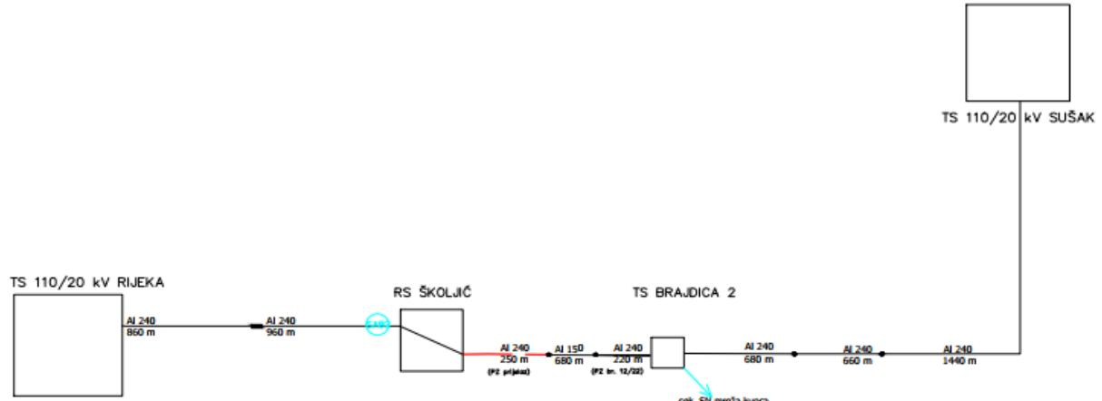
Slika 5.2. Blok shema napajanja terminala Brajdica [6]
