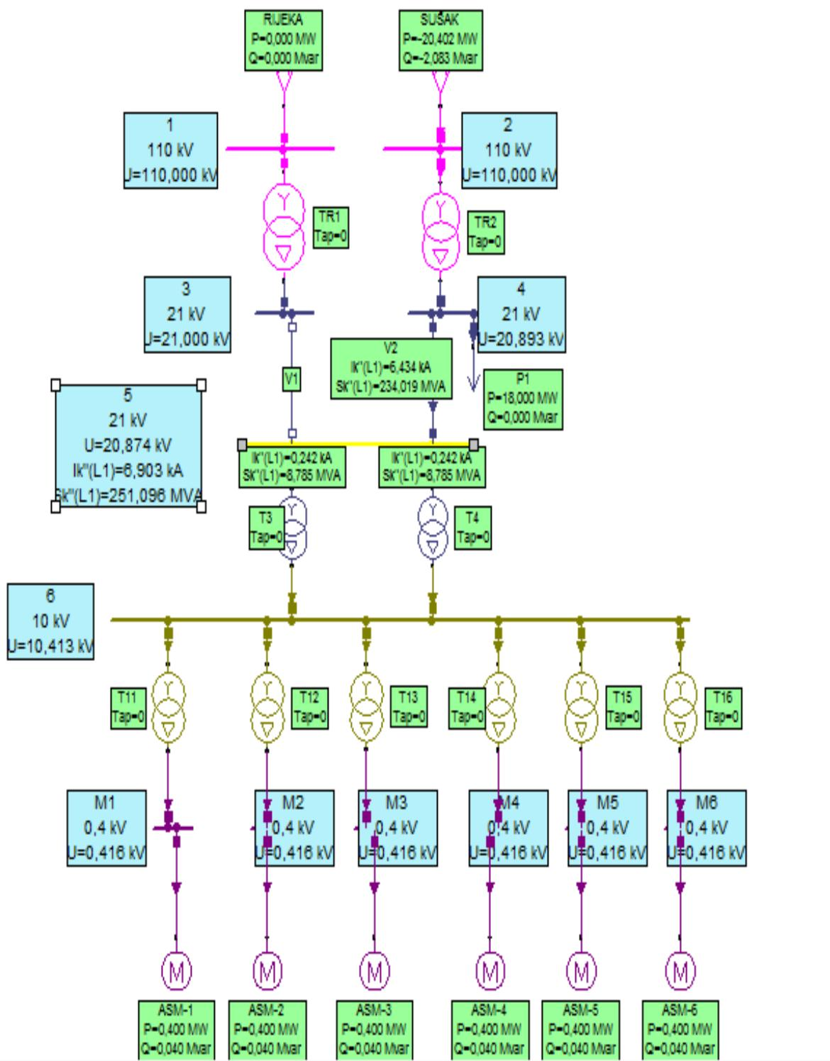
Slika 6.4. Kratki spoj na 20 kV SN postrojenju napajan iz TS 110/10(20) kV Sušak
