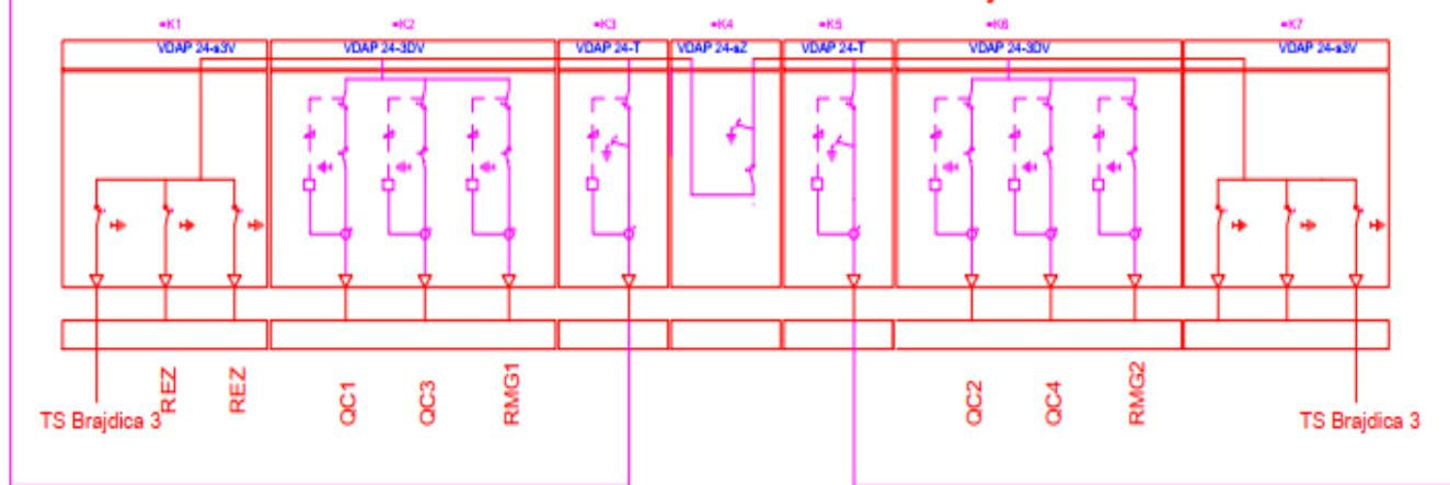
Slika 5.6. Novopredviđeno stanje TS 20/10/0,4 kV Brajdica 2 [6]
