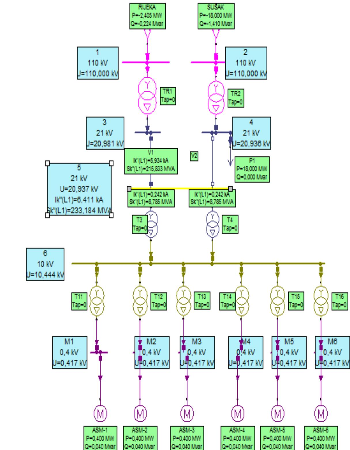
Slika 6.2. Kratki spoj na 20 kV SN postrojenju napajan iz TS 110/10(20) kV Rijeka
