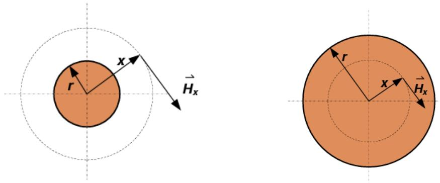
Slika 3.1. Magnetsko polje izvan i unutar vodiča
