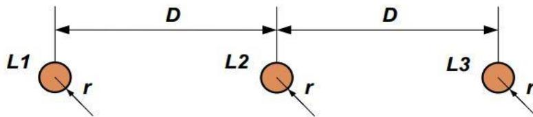
Slika 4.1. Horizontalni raspored vodiča
