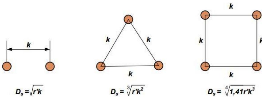
Slika 3.5. Reducirani vlastiti SGU za vodiče u snopu
