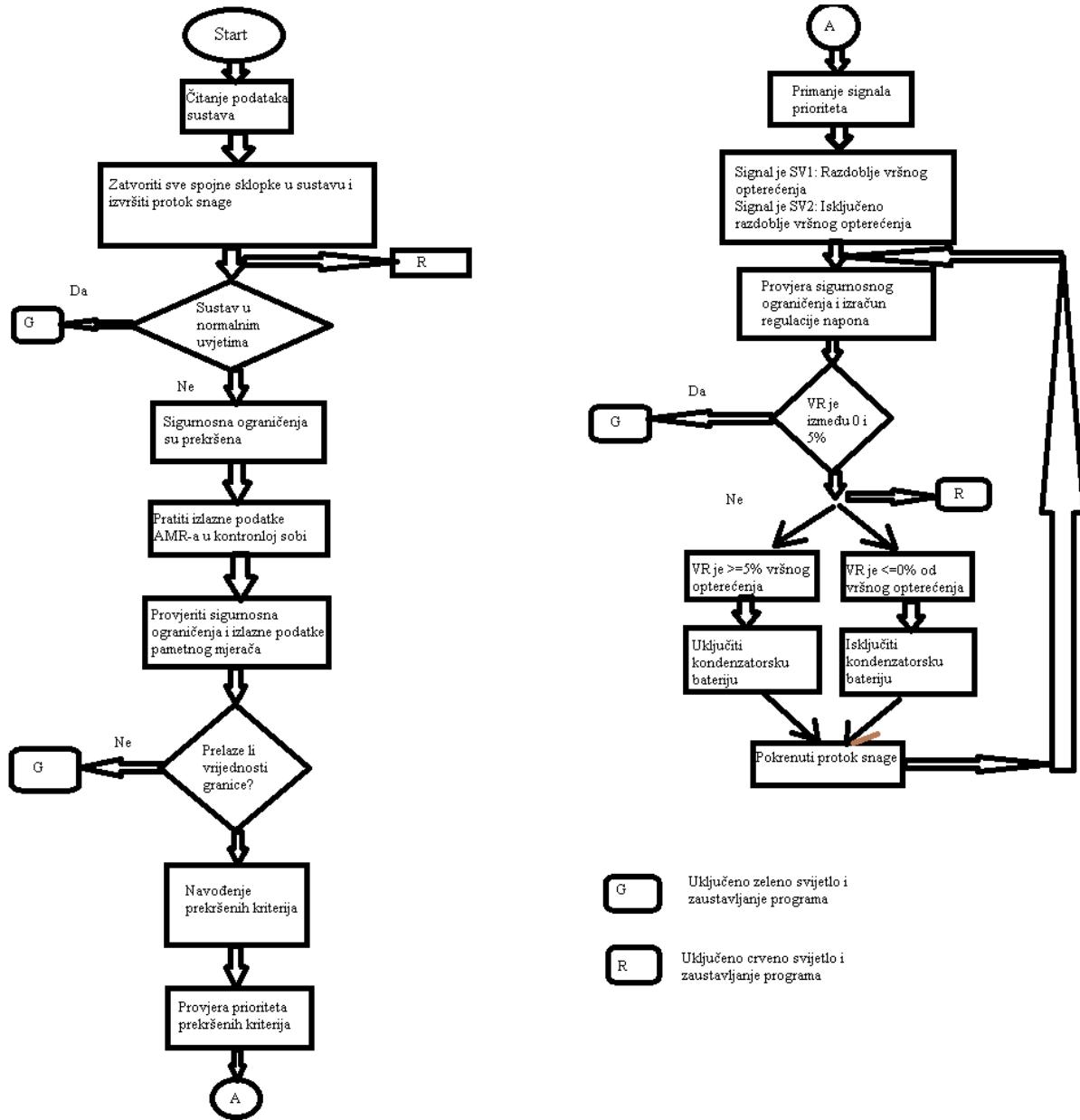
Slika 3.3. AMR distribuiran D-SCADA algoritmom upravljanja [6]
