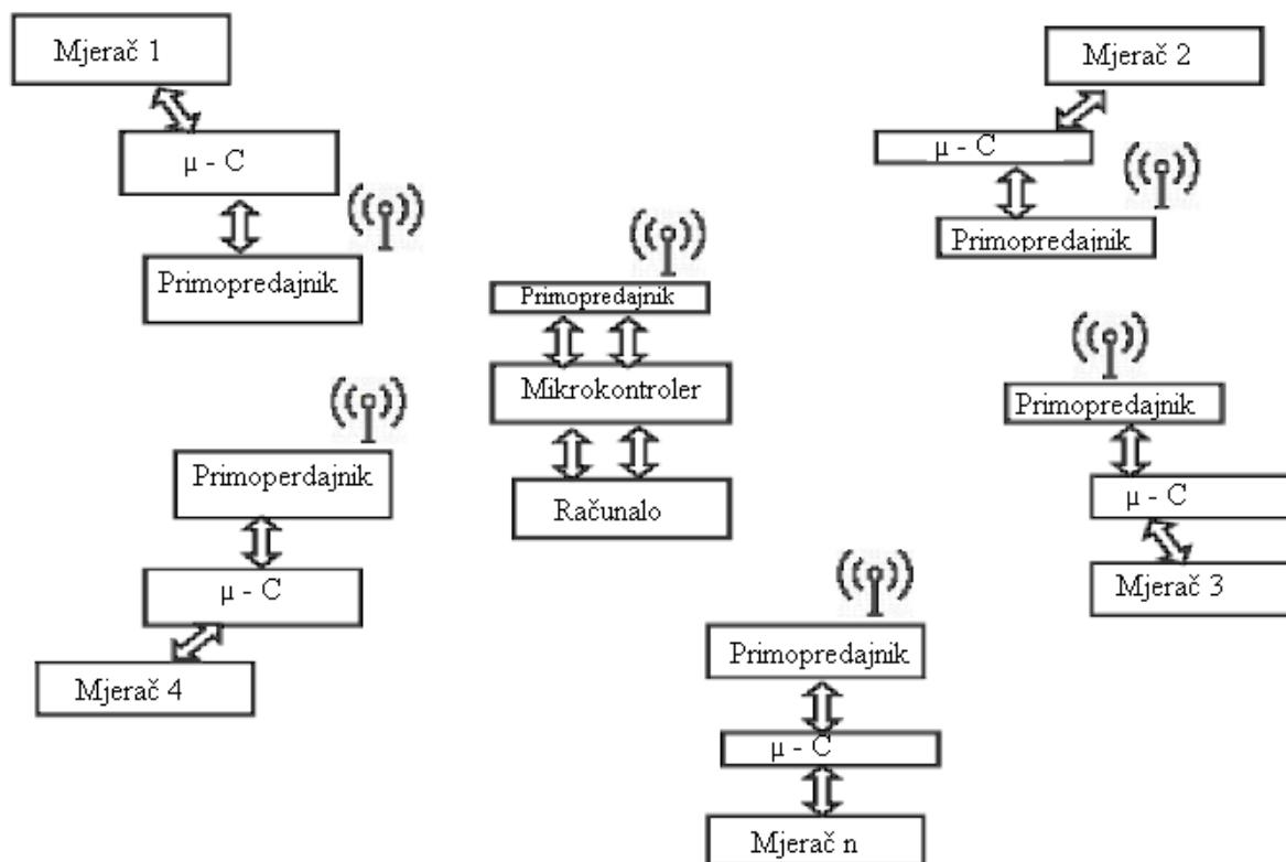
Slika 3.5. Konceptualni dijagram AMR-a baziranog na WiMAX tehnologiji [8]
