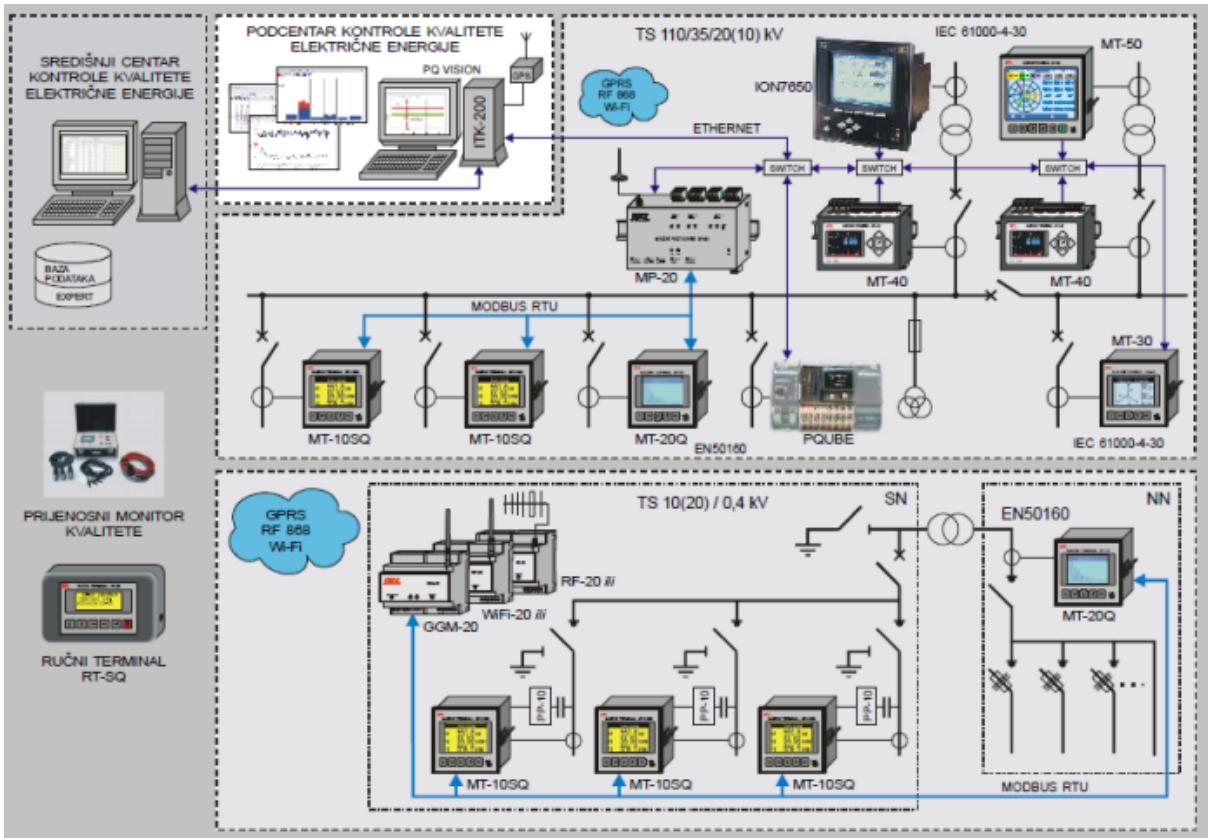
Slika 8.14. Sustav kontrole kvalitete električne energije IPQS [19]
