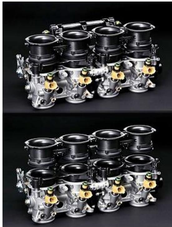
*Slika 3.5. Usisni sustav s trubicama promjenjive duljine [10]*
