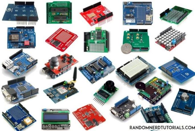
Slika 2.4. Arduino shield pločice [3]
