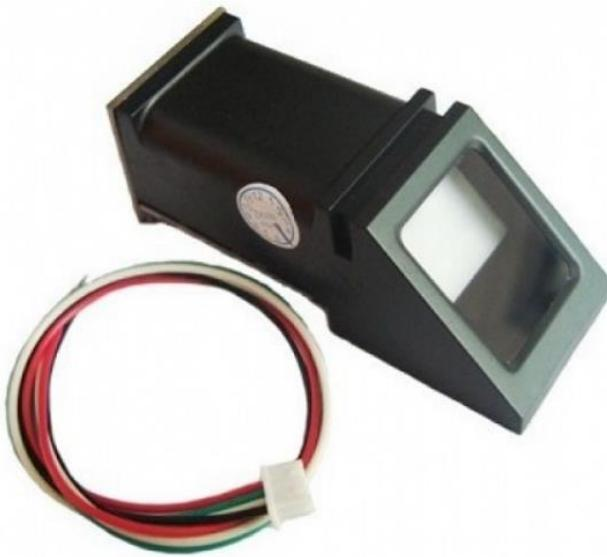
Slika 3.2. Senzor otiska prsta DY50 [5]
