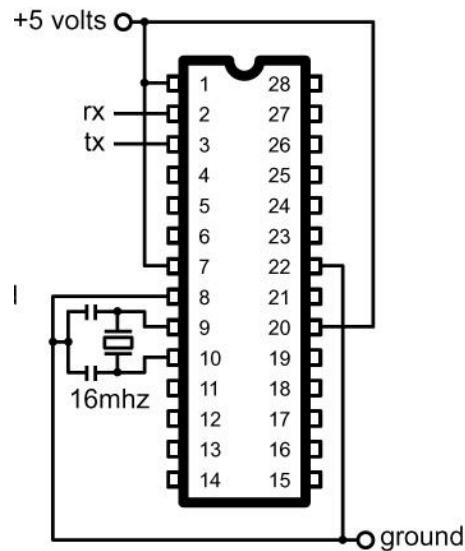
Slika 2.3. Shema spajanja oscilacijskog kruga mikrokontrolera ATmega 328p [2]
