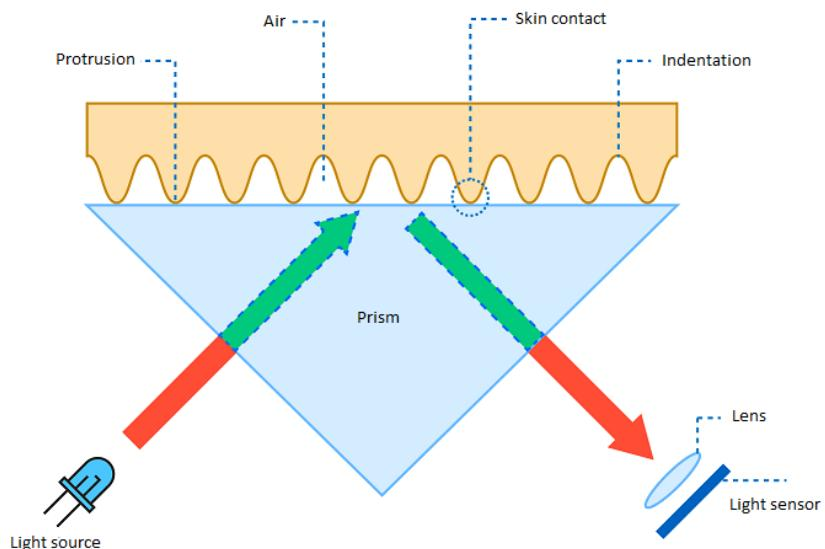
Slika 3.1. Princip rada senzora otiska prsta [4]
