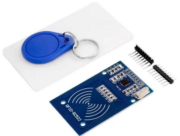
Slika 3.3. RFID senzor te prijenosni uređaji (tagovi) [6]
