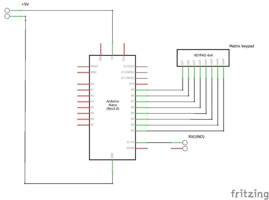
Slika 4.6. Shema spoja razvojne pločice Arduino Nano
