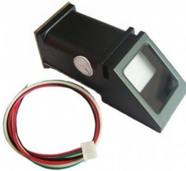
Slika 3.2. Senzor otiska prsta DY50 [5]
