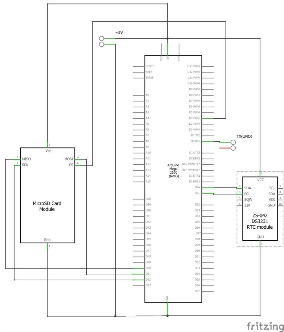
Slika 4.5. Shema spoja razvojne pločice Arduino Mega
