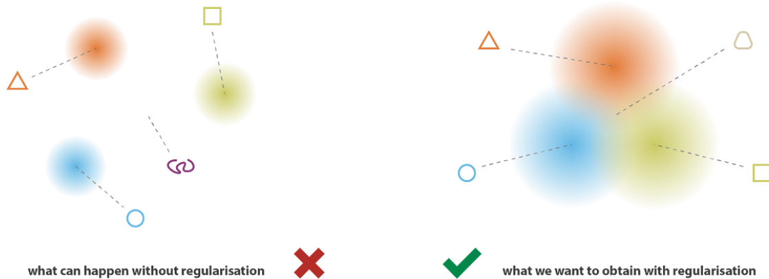
Slika 3.4. Prikaz latentnog prostora i podataka bez regularizacije (lijevo) i s regularizacijom (desno) (preuzeto iz [12])
