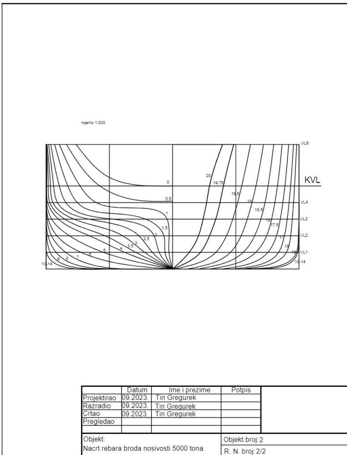
*Slika 2.3. Nacrt rebara (lijevo krma, desno pramac)*
