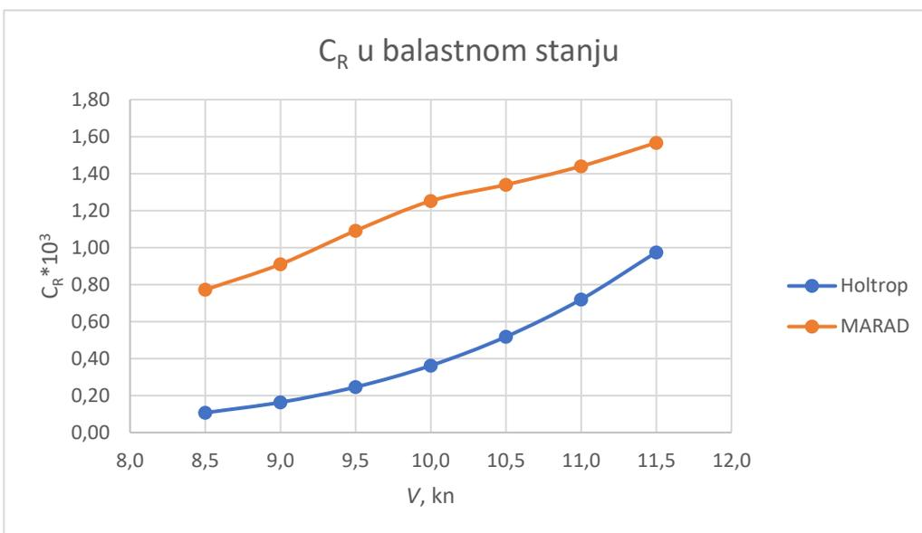
Slika 4.12. Usporedba  $C_R$  za brod u balastu
