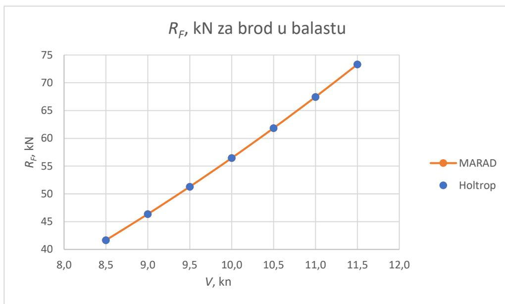
Slika 4.10. Usporedba  $R_F$  za brod u balastu
