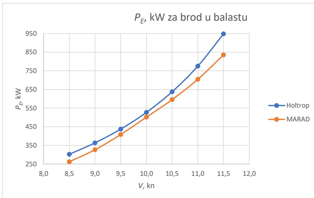
Slika 4.16. Usporedba snage za brod u balastu
