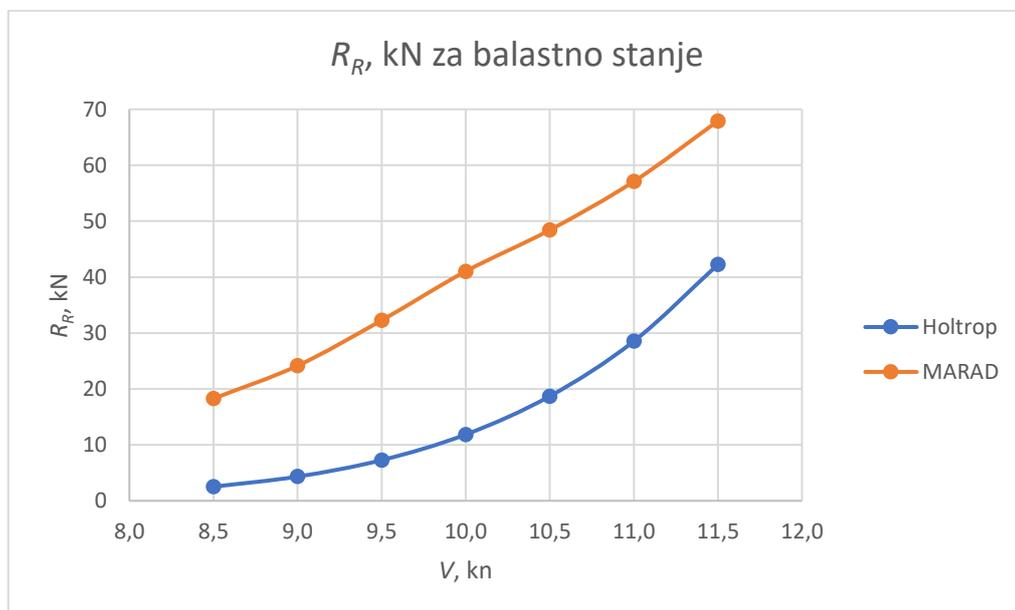
Slika 4.8. Usporedba  $R_R$  za brod u balastu
