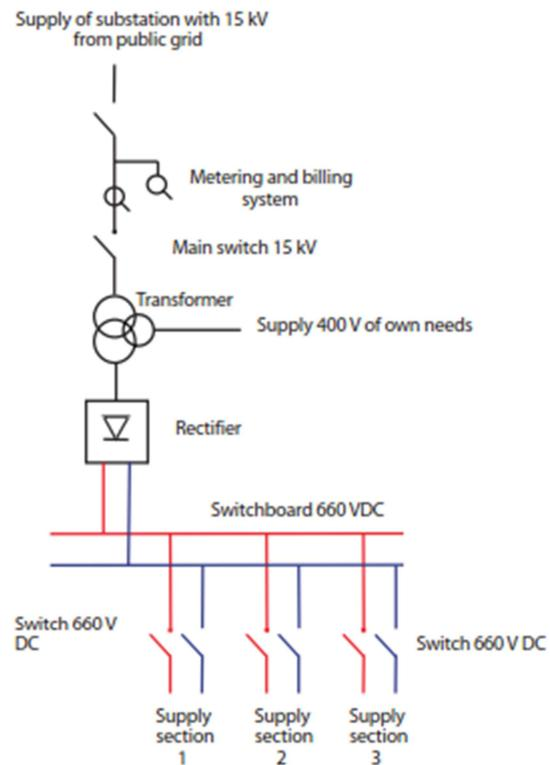
Slika 3.10. Shema trafostanice s jednim pretvaračem. [10]
