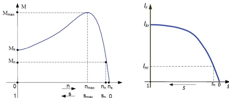
Slika 2.8. Tipični oblik momentne karakteristike asinkronog motora
