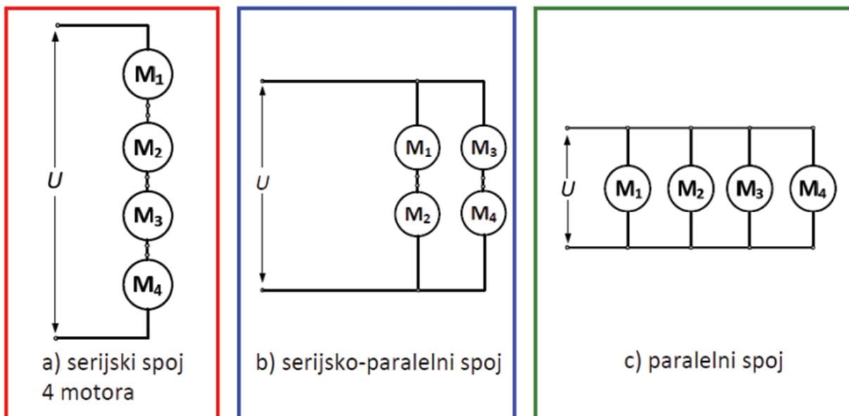
Slika 2.5. Prespajanje pri pokretanju vučnog vozila s 4 serijski uzbudžena motora
