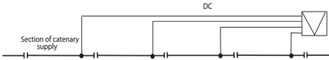
Slika 3.7. Shema centraliziranog napajanja kontaktne mreže. [10]
