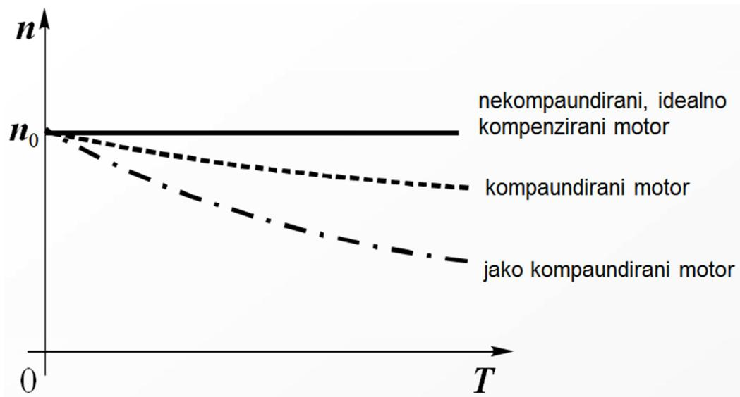
Slika 3.18. Vanjske karakteristike kompaundiranog motora
