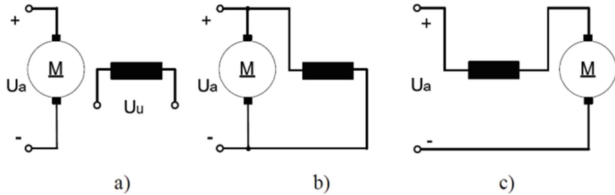
Slika 2.4. Sheme različitih uzbuda DC motora: a) nezavisna, b) paralelna i c) serijska
