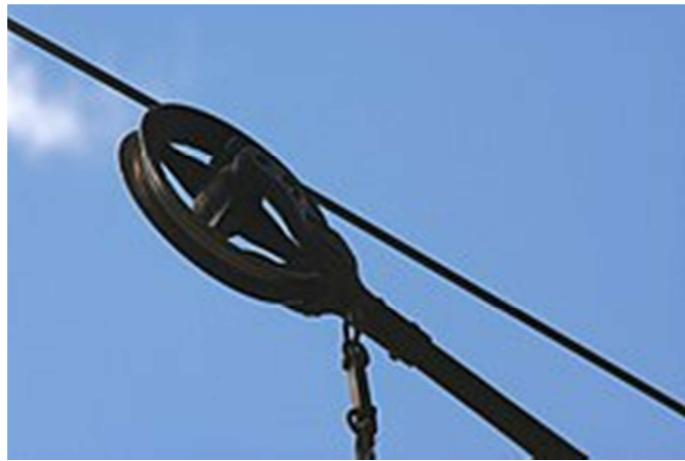
Slika 3.4. Primjer kontaktnog kotača na oduzimaču struje.
