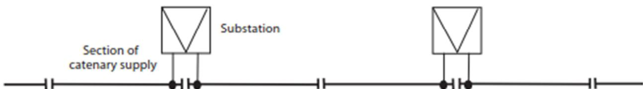
Slika 3.8. Shema decentraliziranog napajanja kontaktne mreže. [10]
