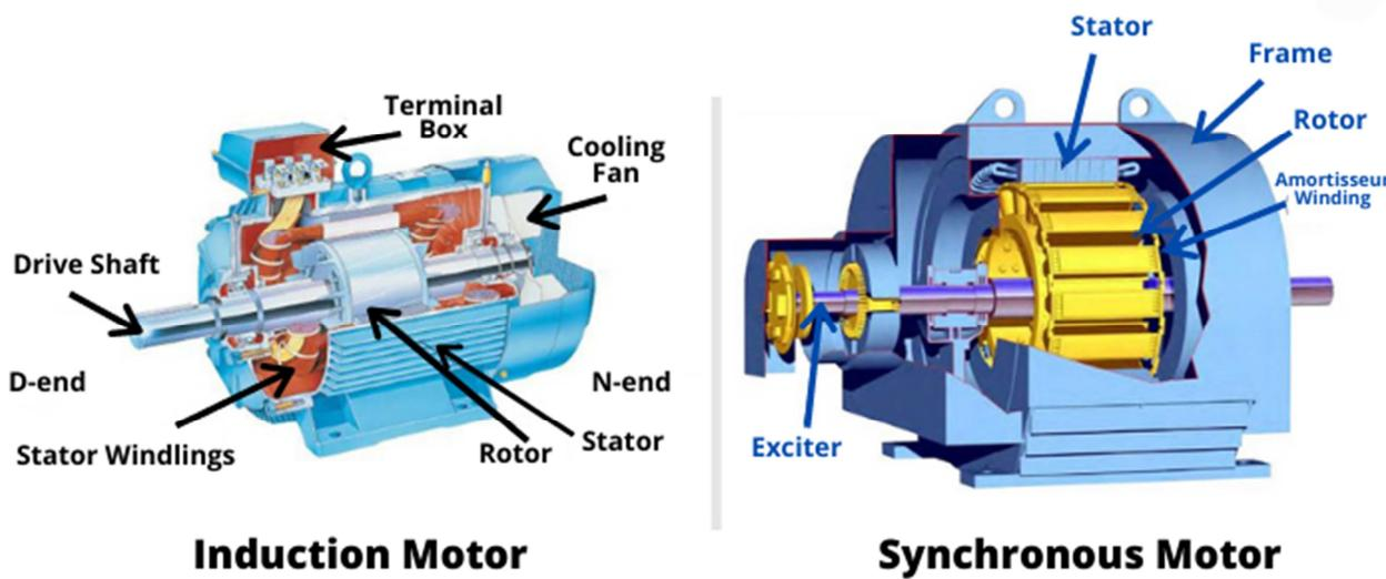
Slika 2.6. Asinkroni i sinkroni izmjenični motor
