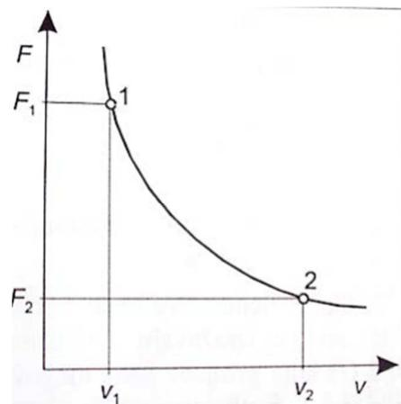
Slika 3.19. Vučna značajka istosmernog serijskog elektromotora
