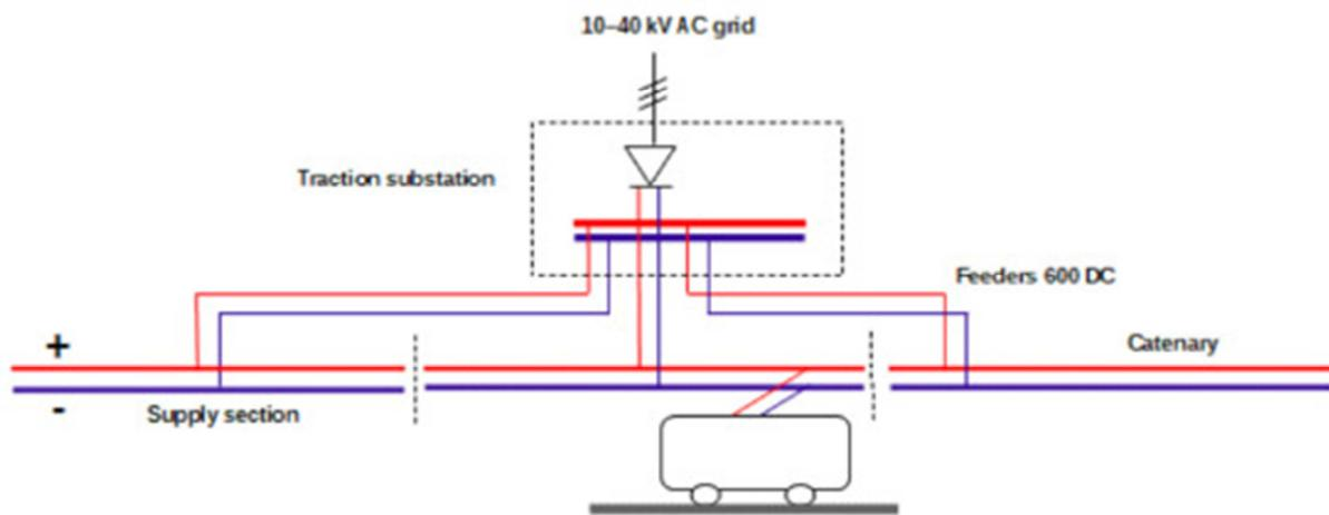
Slika 3.12. Shematski prikaz trafostanice za trolejbusnu kontaktnu mrežu
