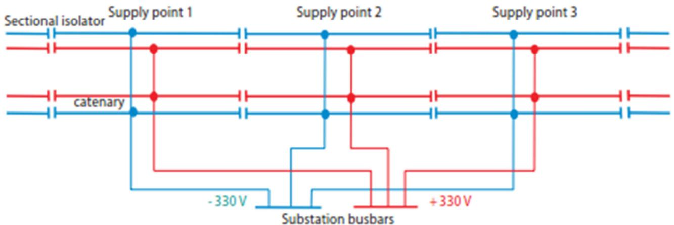
Slika 3.6. Struktura napajanja trolejbusne kontaktne mreže. [10]
