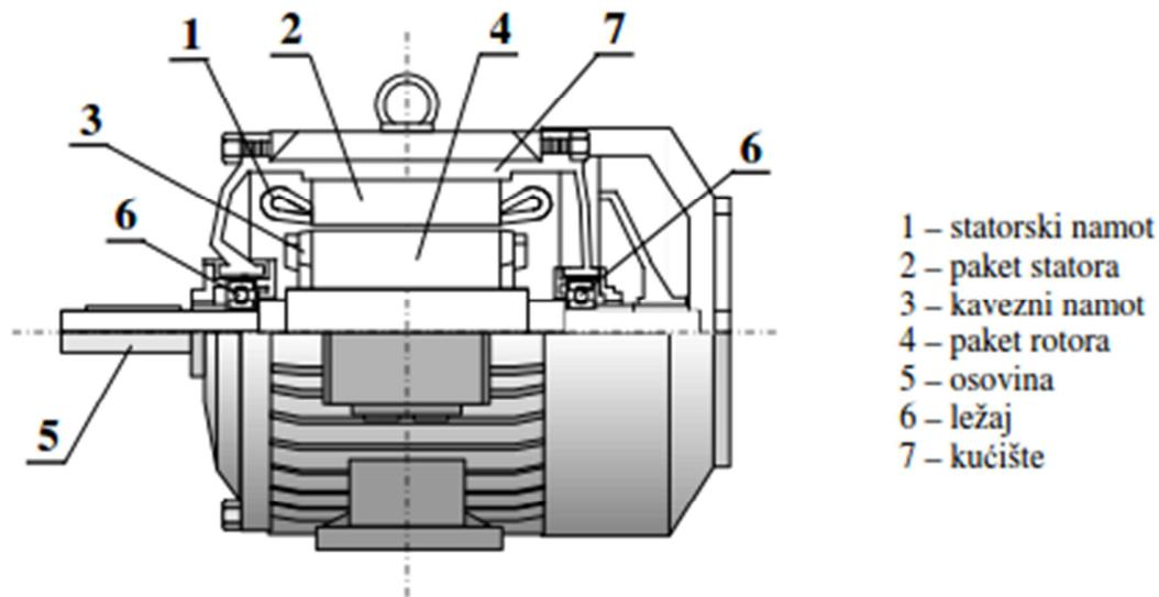
Slika 2.7. Uzdužni presjek gornjeg dijela asinkronog kaveznog motora.[4]
