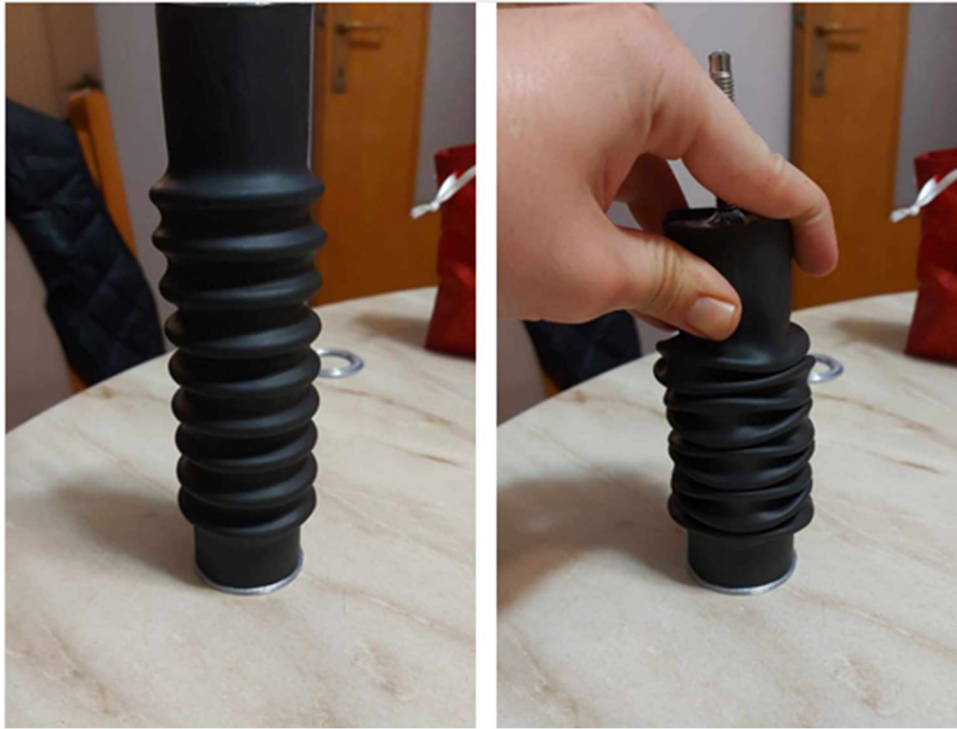
Slika 2.11. Četvrta iteracija ovojnice mišića u početnom i stisnutom položaju
