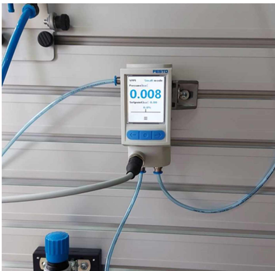
Slika 3.2. Proporcionalni ventil FESTO VPPI-5L-3-G18-1V1H-V1-S1D
