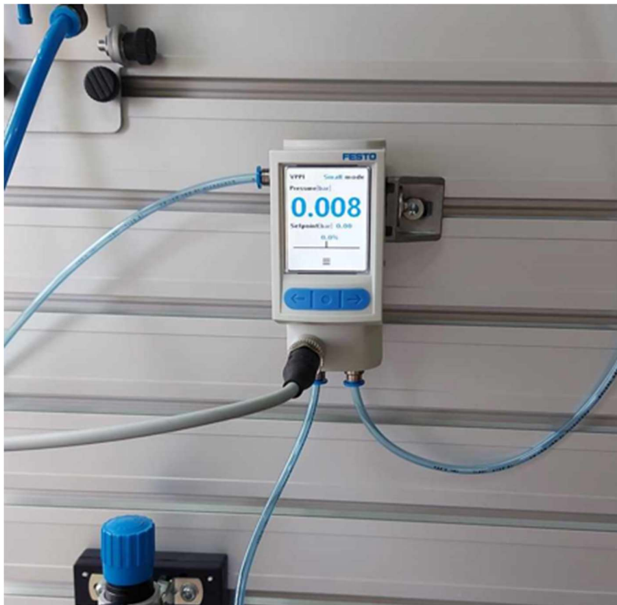
Slika 3.2. Proporcionalni ventil FESTO VPPI-5L-3-G18-1V1H-V1-S1D
