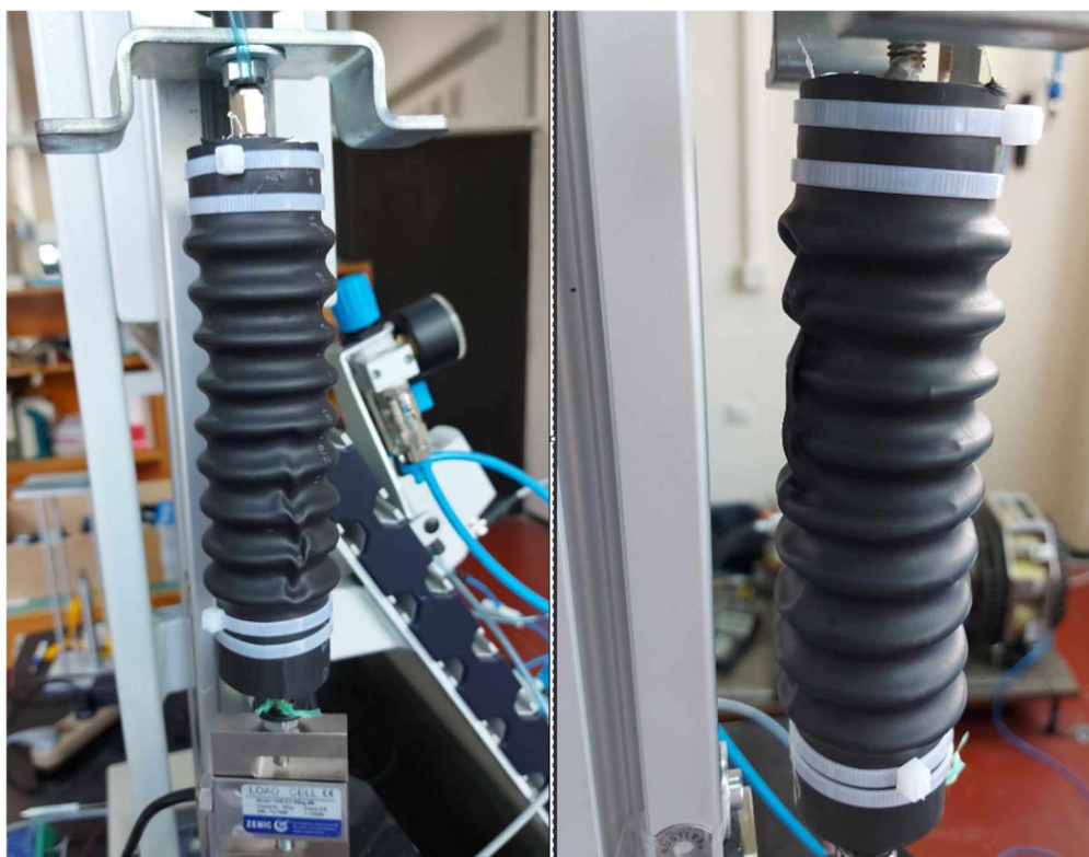
Slika 4.5. Deformacija mišića pri većim podtlacima
