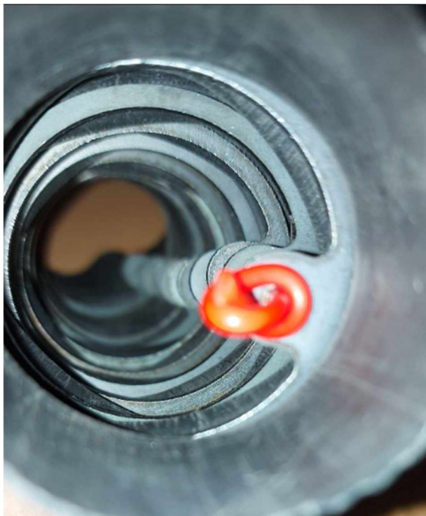
Slika 2.20. Unutrašnjost mišića s kutnim pomakom
