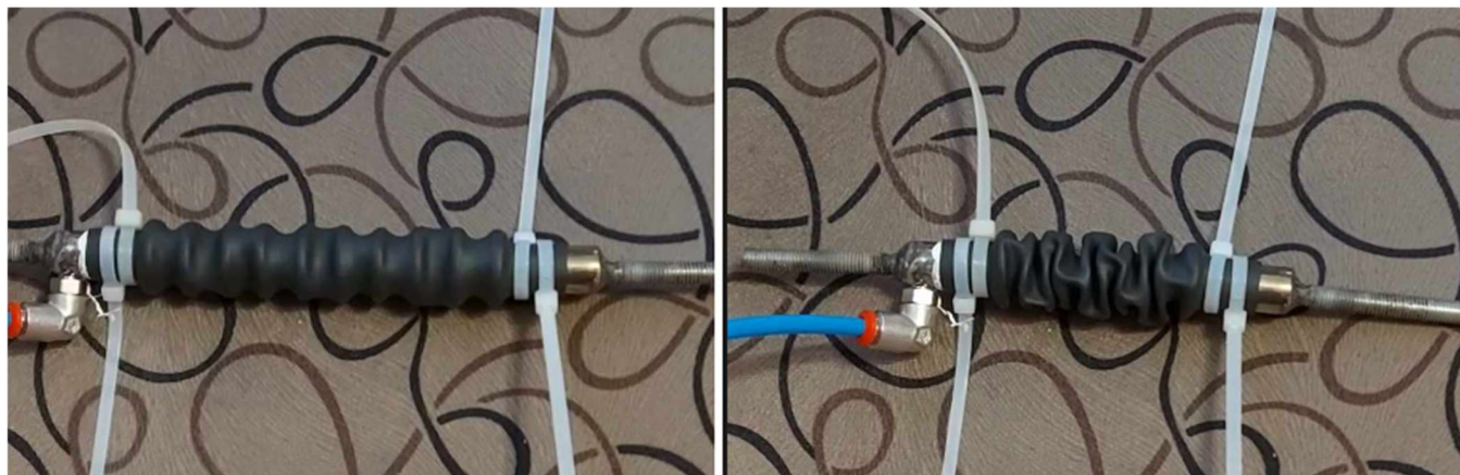
Slika 2.16. Tanji mišić u opuštenom i opterećenom stanju
