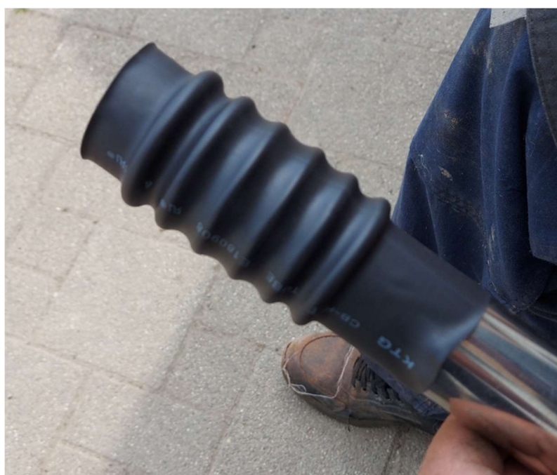
Slika 2.5. Termo-deformabilna polimerna cijev na kalupu nakon zagrijavanja
