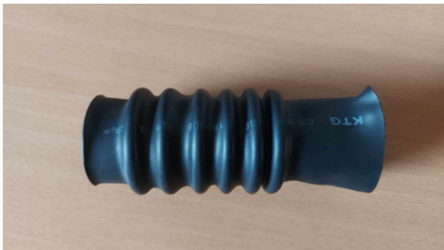
Slika 2.6. Prva iteracija ovojnice mišića nakon izvlačenja cijevi
