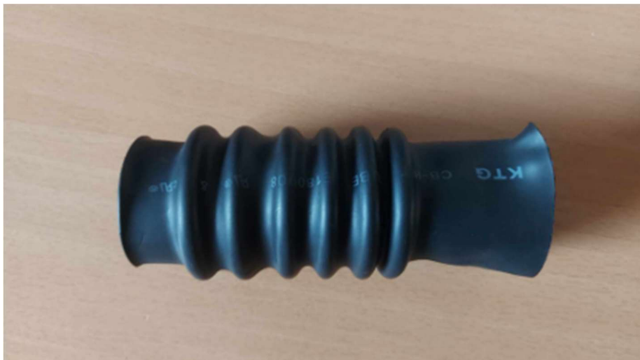
Slika 2.6. Prva iteracija ovojnice mišića nakon izvlačenja cijevi
