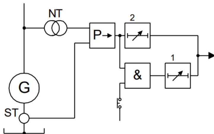
*Slika 4.18. Shema zaštite od povratne snage [10]*
