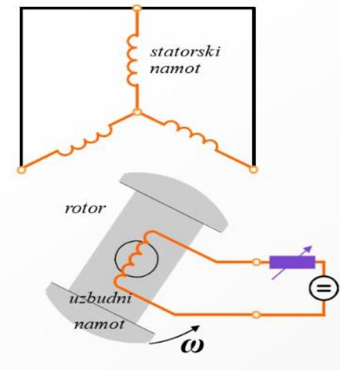
*Slika 2.13. Shema spoja sinkronog generatora u kratkom spoju [3]*
