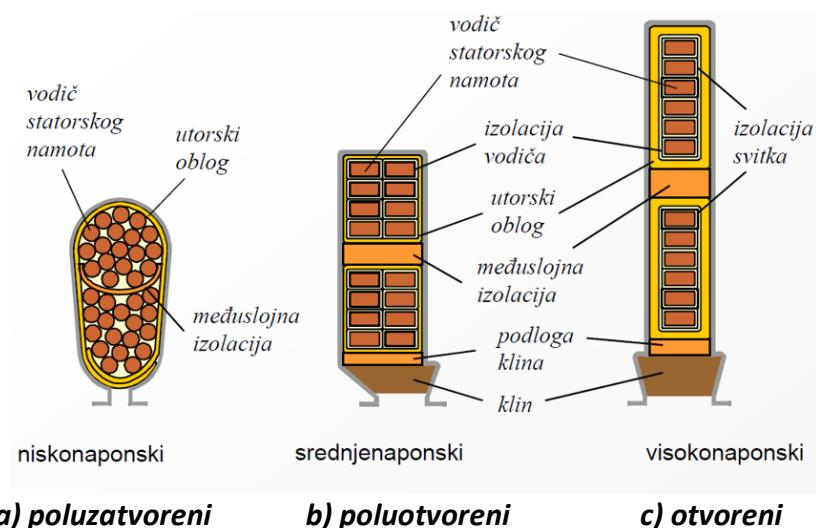
Slika 2.5. Tipični oblici statorskih utora sinkronog stroja [3]
