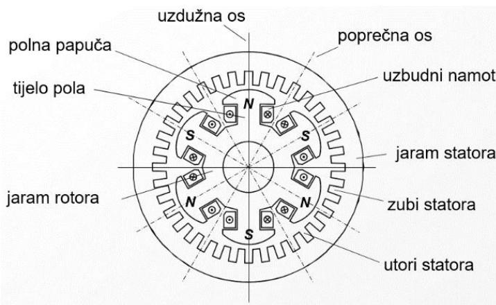
*Slika 2.2. Presjek magnetskog kruga s istaknutim 6-polnim uzbudnim namotom [3]*
