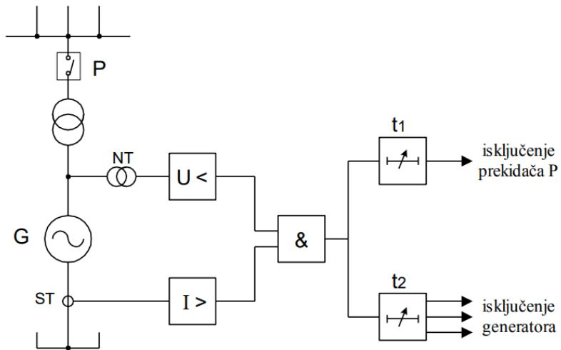
*Slika 4.12. Pojednostavljena shema nadstrujne zaštite s podnaponskim reljem [10]*
