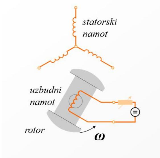
*Slika 2.12. Shema spoja sinkronog generatora u praznom hodu [3]*
