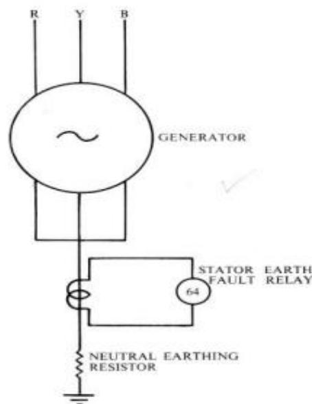
*Slika 4.5. izvedba s uzemljenjem otpornika [9]*
