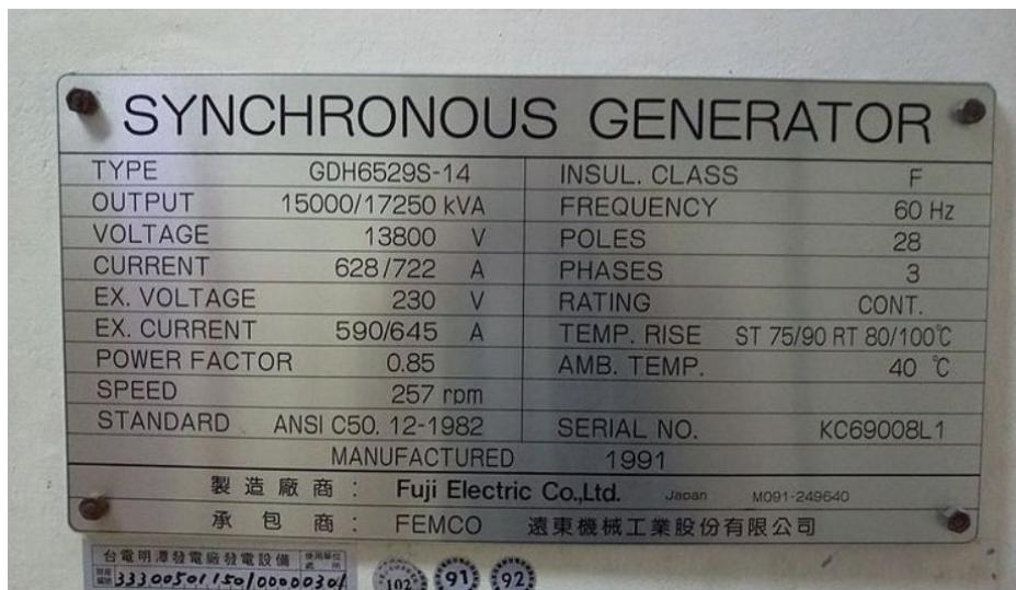
*Slika 2.19. Natpisna pločica sinkronog generatora [5]*
