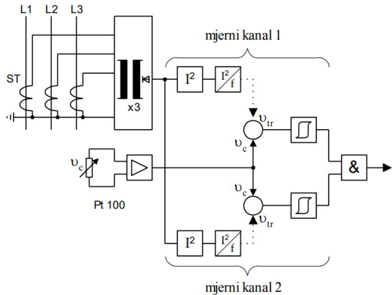
*Slika 4.21. Pojednostavljena shema zaštite od preopterećenja generatora s dvostrukim termičkim kanalima [10]*
