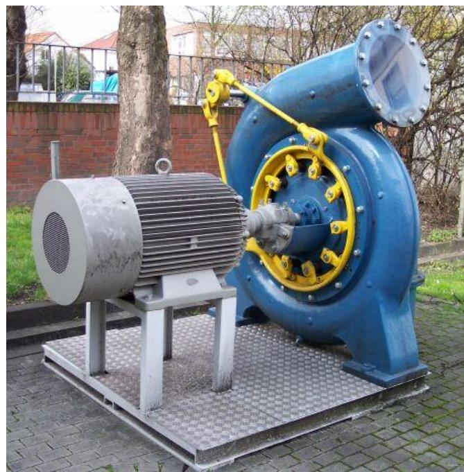
*Slika 2.14. Hidrogenerator postavljen horizontalno s osovinom [3]*
