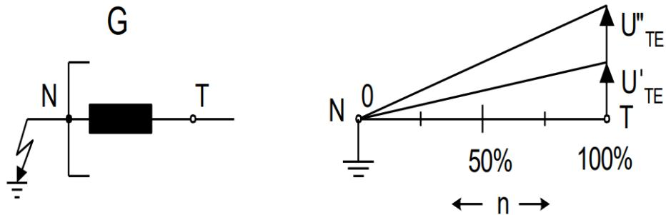
*Slika 4.6. spoj statora sa zemljom u zvjezdištu N [10]*
