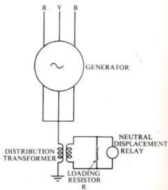
*Slika 4.4. izvedba s uzemljenjem distribucijskog transformatora [9]*
