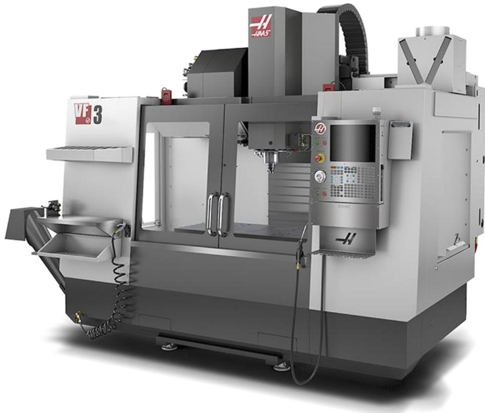
*Slika 5.26 CNC vertikalna glodalica HAAS VF - 3 [5]*
