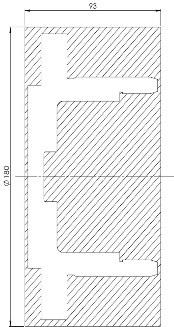
*Slika 3.1 Ulagni materijal - puna okrugla šipka Ø180 x 93 mm*
