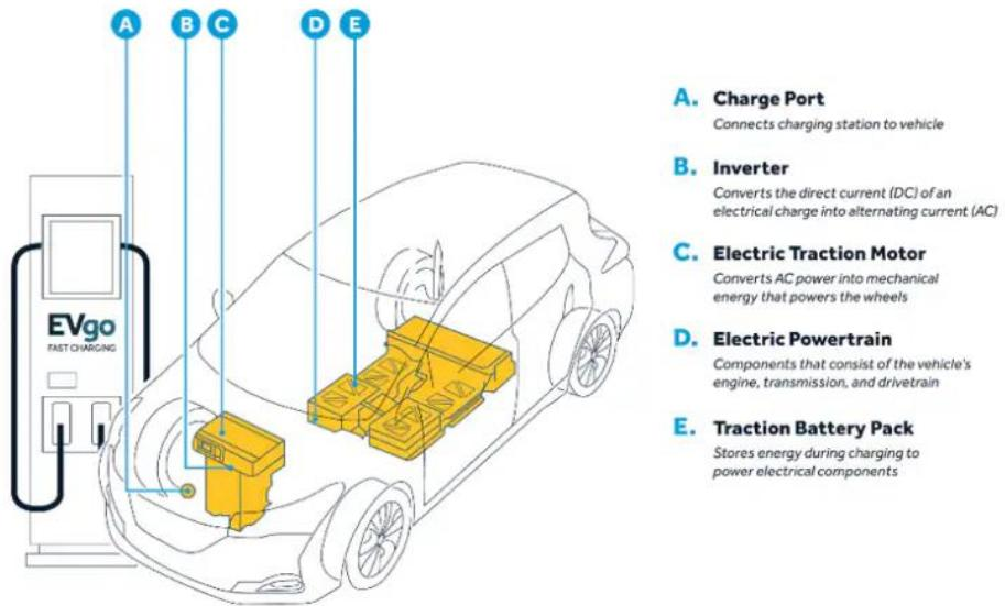
Slika 2.3: Grubi prikaz esencijalnih komponenti električnog automobila [6]
