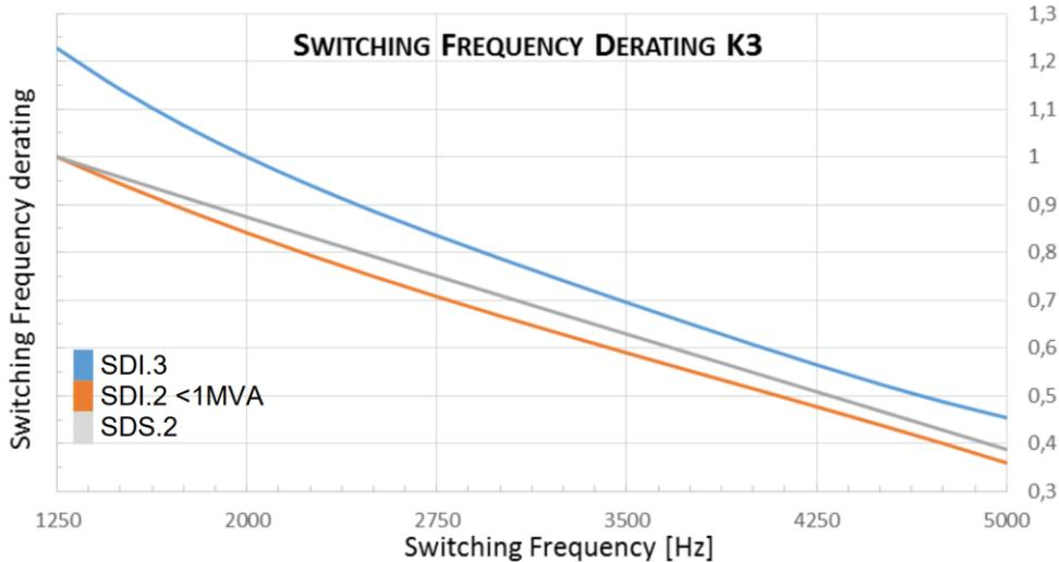
Slika 4.3. Koeficijent dopuštenog trajnog opterećenja električnih energetskih modula [8]
