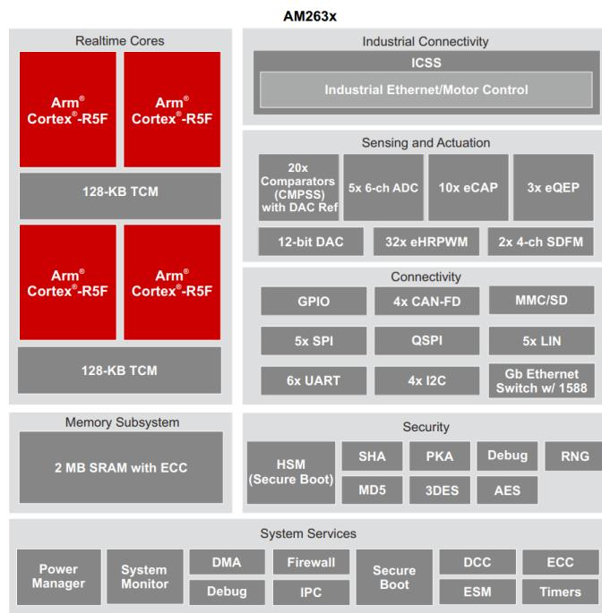
Slika 2.2. Funkcijski blok dijagram mikrokontrolera AM2634 [2]
