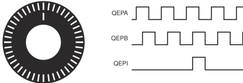
Slika 2.6. Disk i impulsi inkrementalnog enkodera [3]
