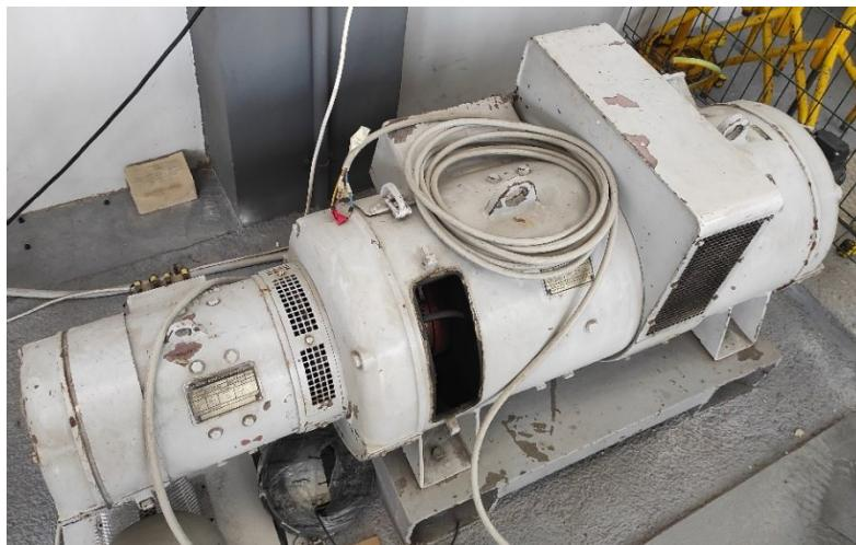
Slika 4.5. Laboratorijski asinkroni stroj 26kW
