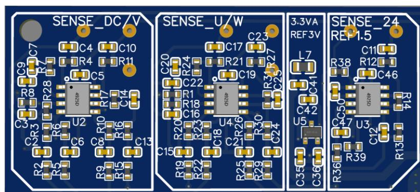
Slika 5.10. Dio tiskane pločice za obradu analognih signala
