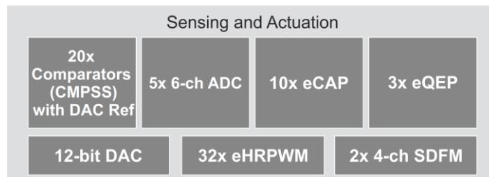
*Slika 2.3 Funkcijski dijagram podsustava za povezivanje senzora i aktuatora [2]*
