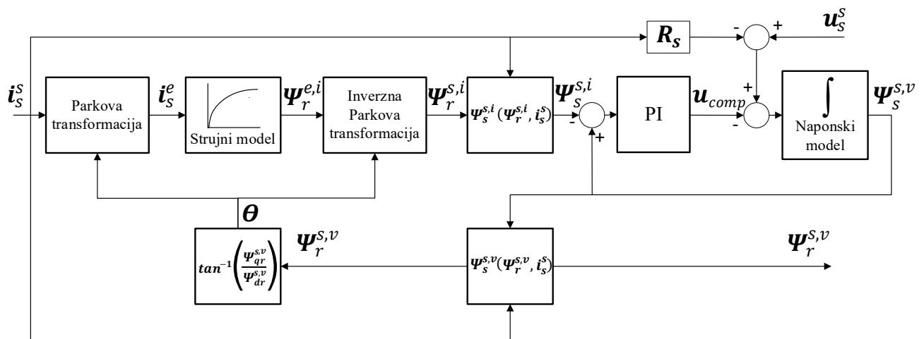
Slika 3.2. Blok shema estimatora toka rotora [6]
