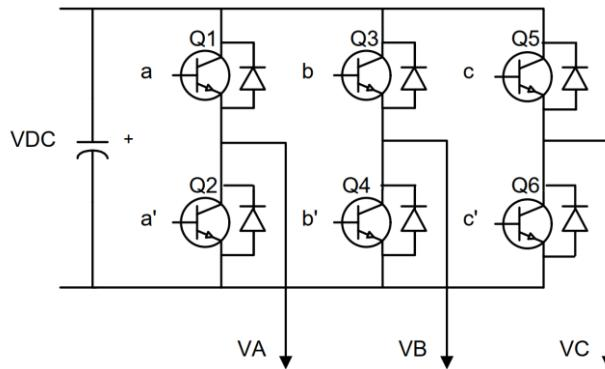
Slika 10.3. Topologija izlaznog stupnja invertera s utisnutim naponom [7]
