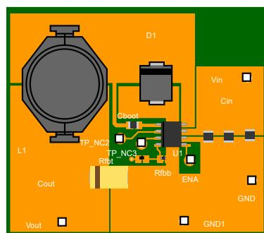
Slika 5.4. Preporučeni raspored elemenata na tiskanoj pločici
