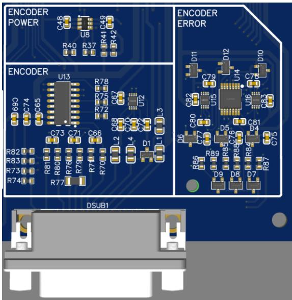
Slika 5.15. Sekcija za prilagodbu signala s inkrementalnog enkodera
