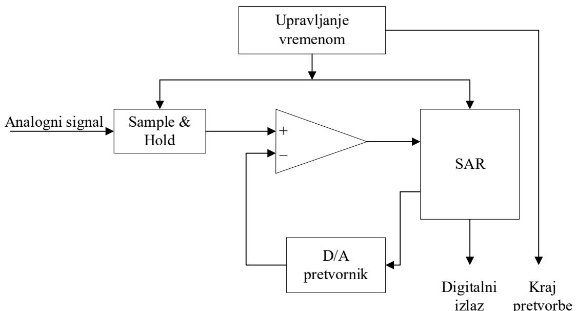
Slika 2.5. Osnovni blok dijagram SAR AD pretvornika
