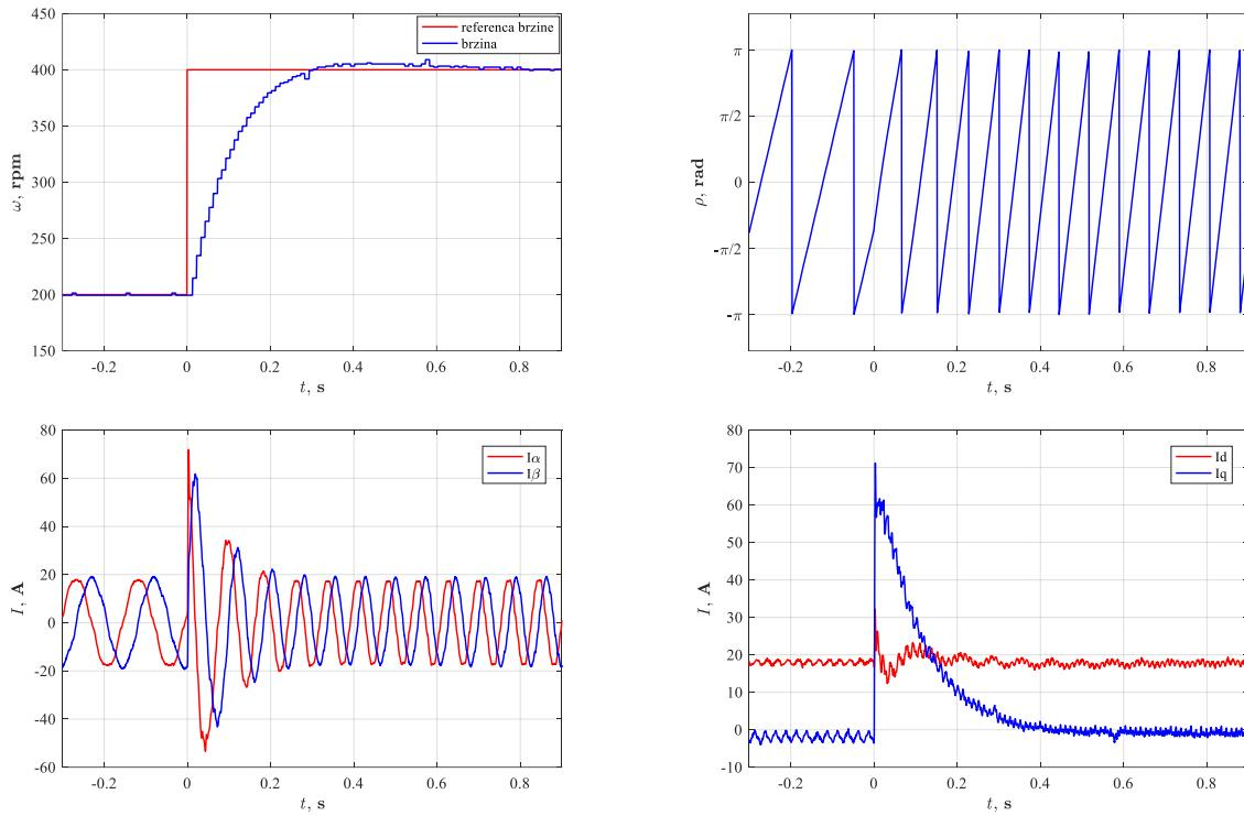
Slika 7.6. Odzvi pokusa skokovite promjene reference brzine vrtnje s iznosa 200 na 400 okr/min
