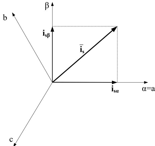
Slika 10.1. Vektor statorske struje i njegove komponente u dvoosnom stacionarnom  $\alpha\text{-}\beta$  koordinatnom sustavu [13]
