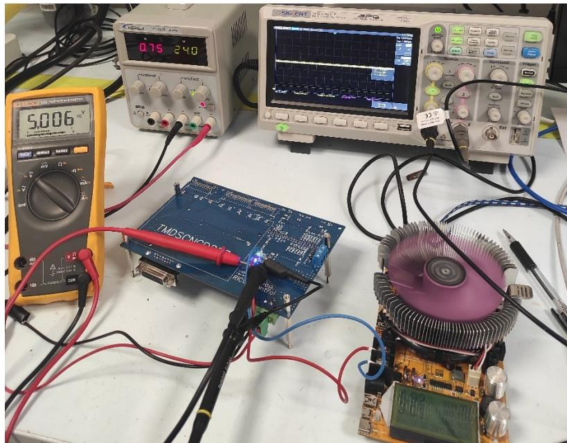
Slika 5.7. Testiranje silaznih pretvarača na izrađenom prilagodnom sučelju
