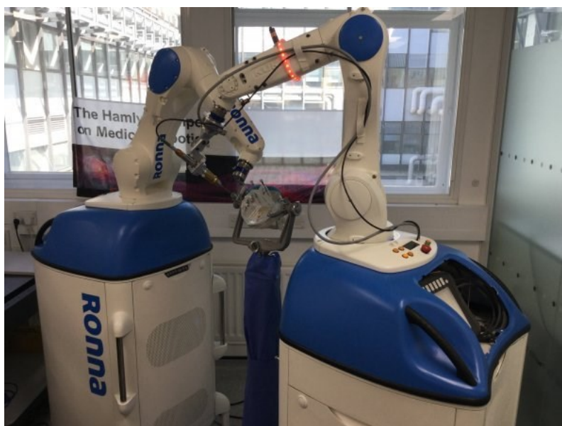
Slika 2.1- Medicinska robotska ruka s 6 stupnjeva slobode gibanja [3]
