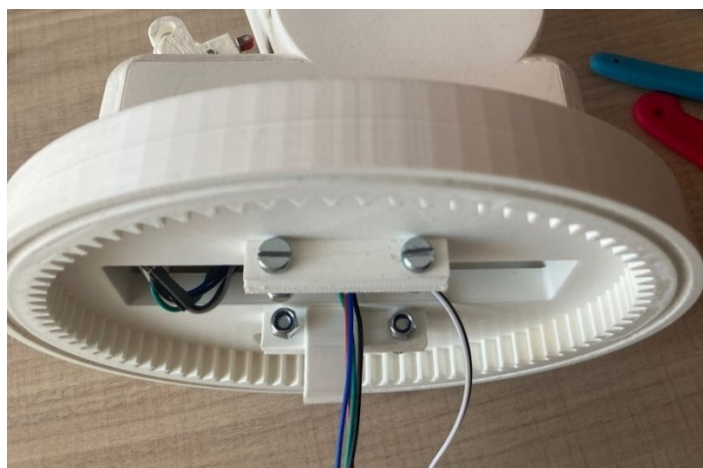
Slika 6.7-Montaža zgloba 1 i gornjeg dijela postolja
