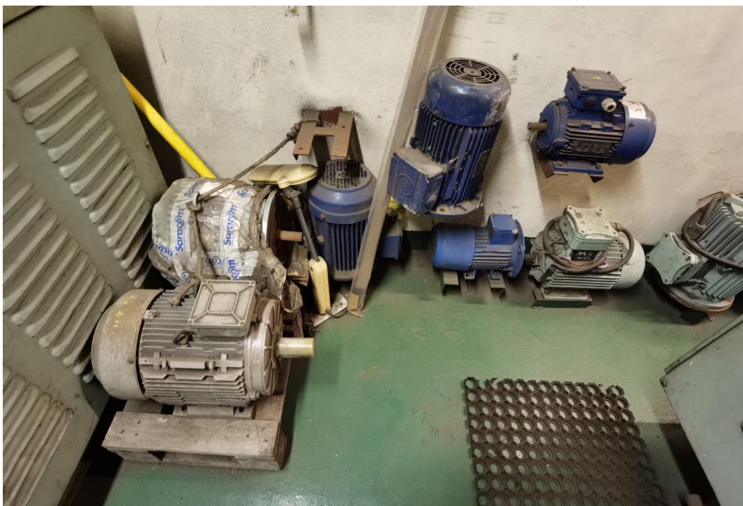
Slika 6.4. Rezervni elektromotori na brodu (za razne uređaje)
