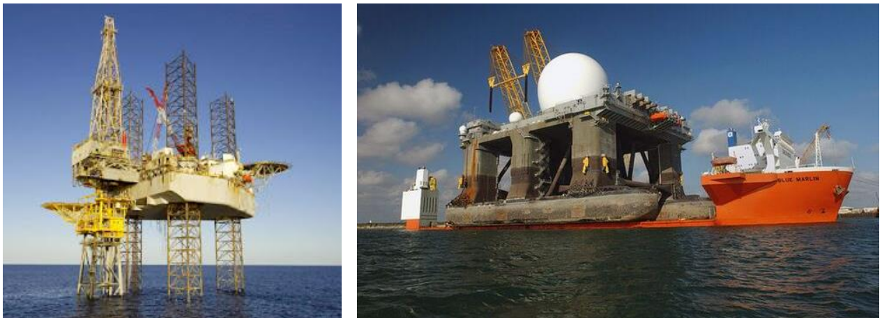
Slika 4.1. Samoodrživa platforma (lijevo); Jack-up brod za prijevoz ekstremno velikih pomorskih objekta (desno) [27] [28]
