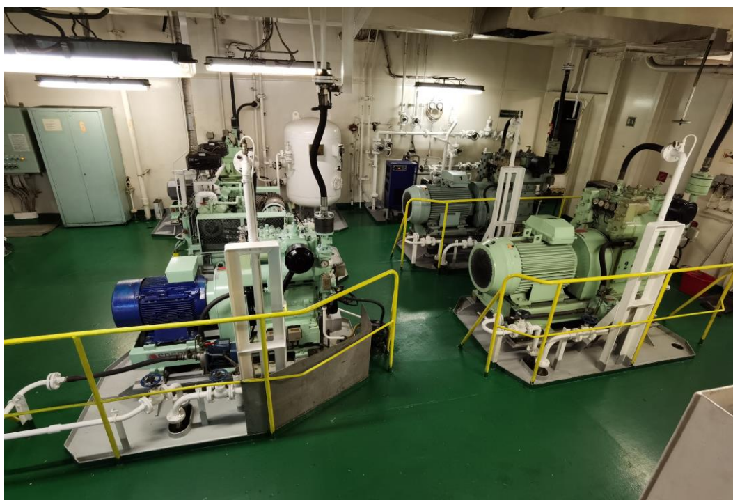
Slika 6.5. Kompresori pogonjeni elektromotorima
