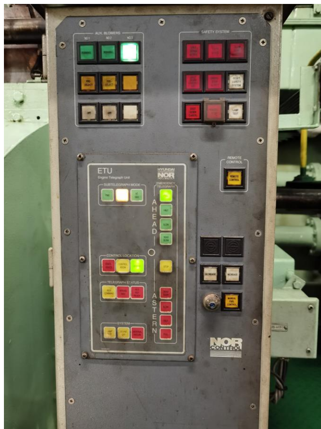
Slika 11.2. Upravljači za vitla (lijevo); Upravljačka jedinica za direktno upravljanje glavnim motorom (desno)
