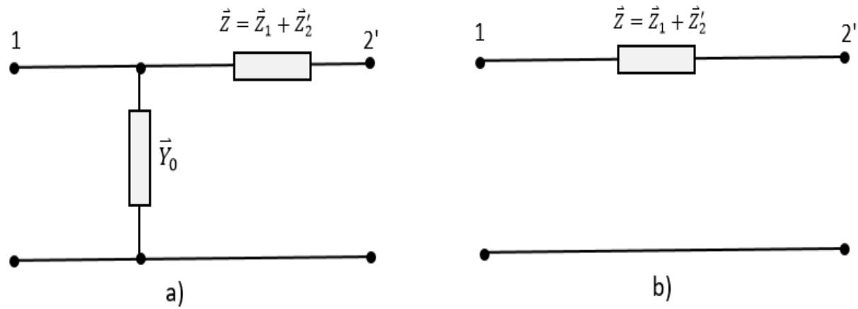
Slika 3.9. a)  $\Gamma$ -shema i b) I-shema transformatora
