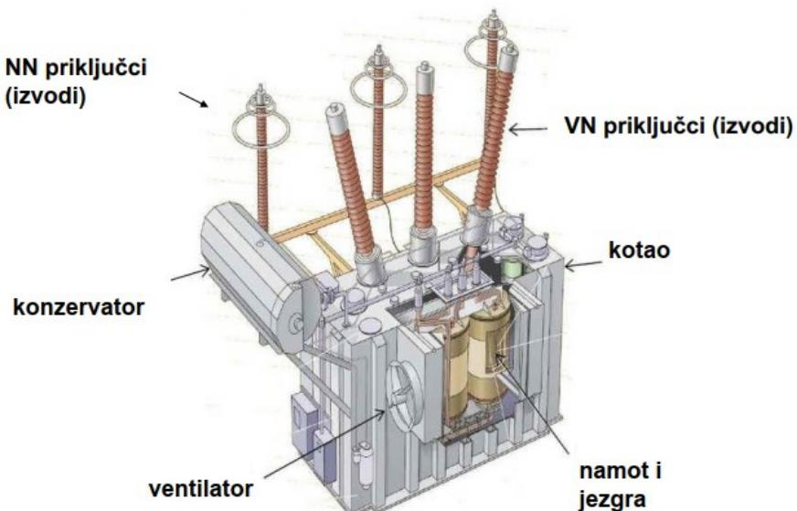
*Slika 2.2. Konstrukcija transformatora*
