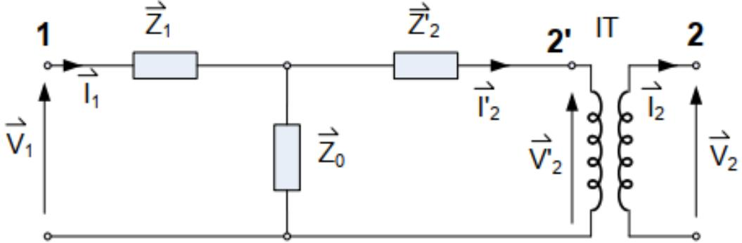
Slika 3.2. Jednofazni dvonamotni transformator preračunato na primarnu stranu
