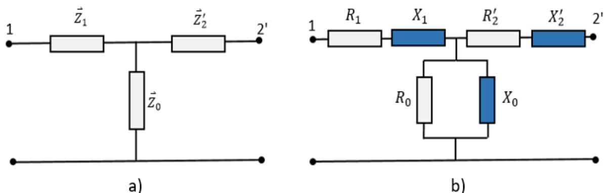
Slika 3.7. T - shema transformatora
