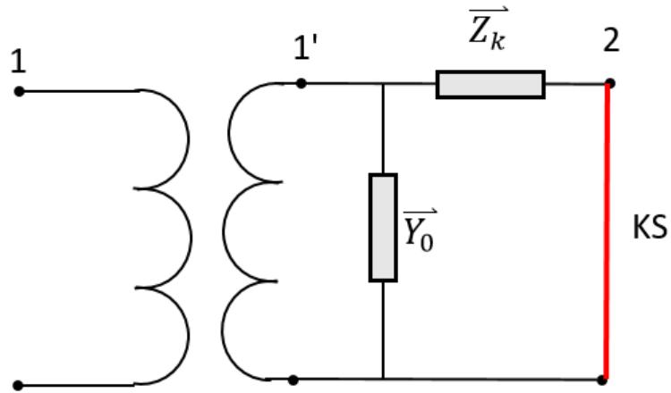
Izračun struje kratkog spoja za vrijednosti relativnog napona kratkog spoja  $u_k = 9\%$ :
