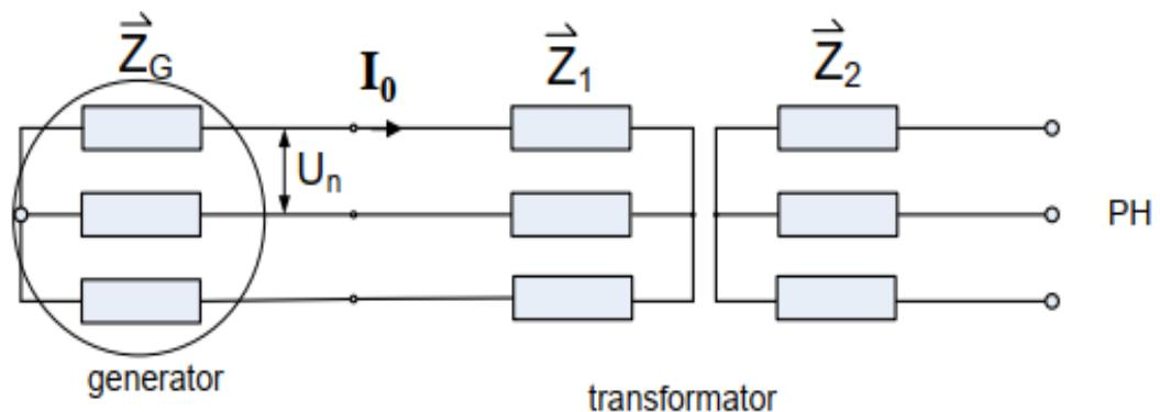
Slika 3.16. Pokus praznog hoda dvonamotnog transformatora
