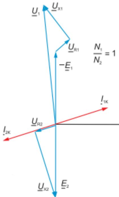
Slika 3.13. Fazorski dijagram kratko spojenog transformatora
