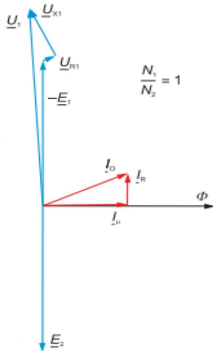
Slika 3.15. Fazorski dijagram praznog hoda transformatora
