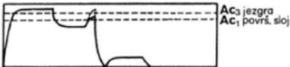
Slika 3.15. Postupka jednostrukog kaljenja nakon izotermičke pretvorbe
