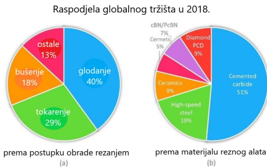
Slika 2.4.3. Udio postupaka obrade odvajanjem čestica (lijevo) i udio pojedinih vrsta reznih materijala (desno) u globalnom tržištu za 2018. [6].
