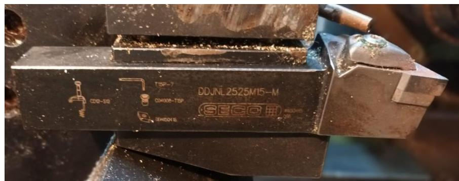
Slika 6.2.1.2. Držač rezne pločice SECO DDJNL 2525M15-M.
