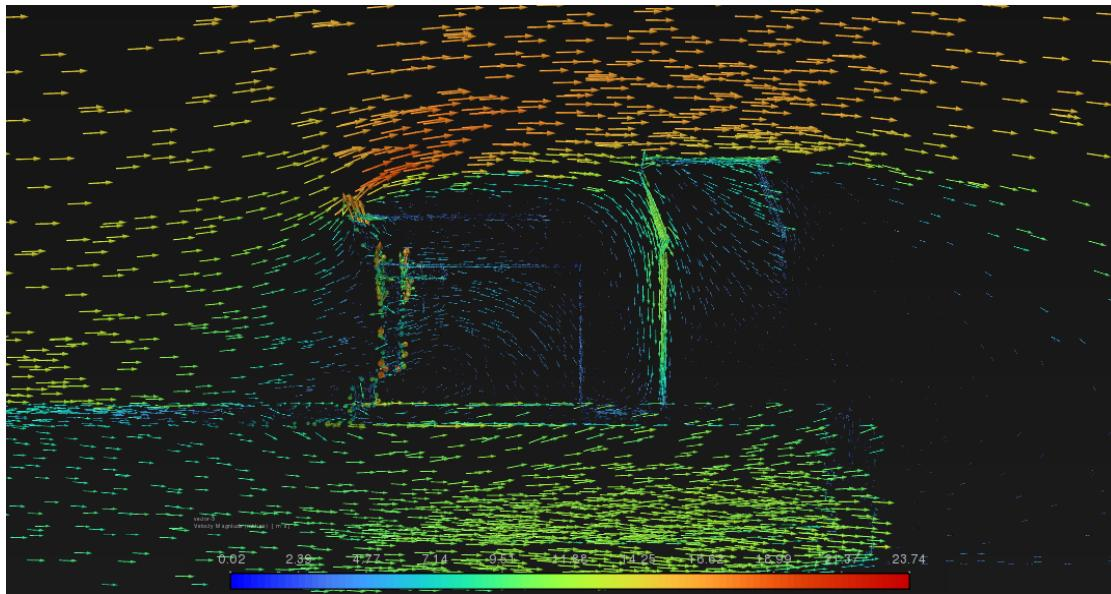
Slika 6.12 Detaljni prikaz vektorskog strujanja oko Nadgrada i Dimnjaka broda
