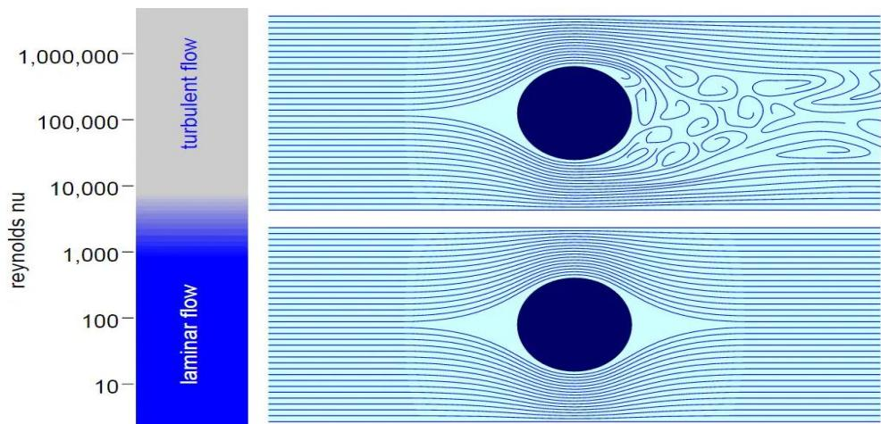
Slika 2.4 Usporedba laminarnog i turbulentnog strujanja [3]
