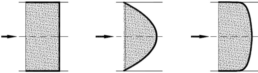
Slika 2.5 Idealan, laminaran i turbulentan oblik profila brzine [1]
