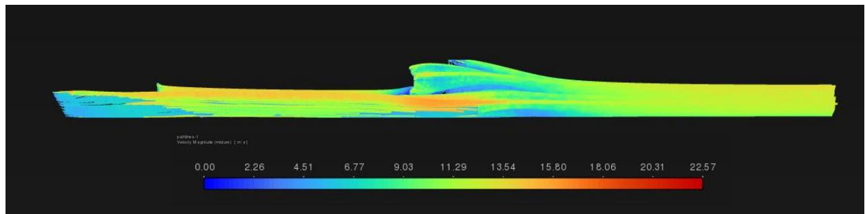
Slika 6.13 Putanje brzina na cijeloj domeni broda
