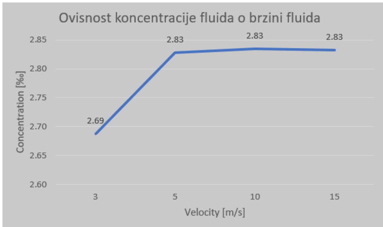
*Slika 6.18 Dijagram ovisnosti koncentracije fluida o brzini fluida*
