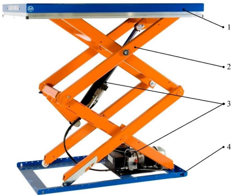
Slika 5. Osnovni dijelovi podizne platforme s škarastim mehanizmom
