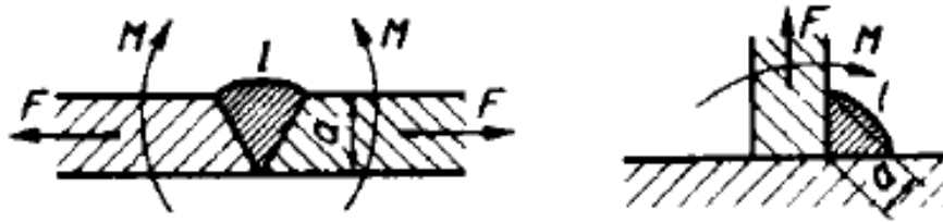
Slika 33. Djelovanje sile i momenta na zavarene spojeve
