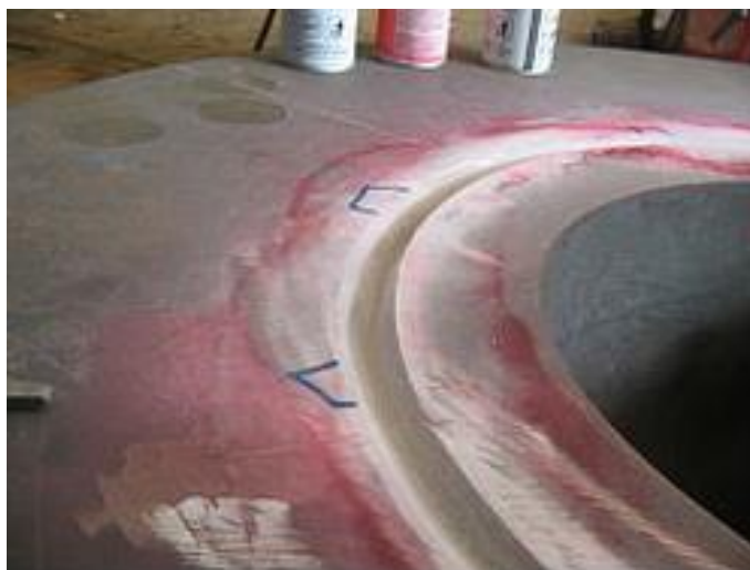
Slika 32. Izgled zavora kod ispitivanja pomoću penetranta
