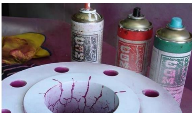
Slika 3.1. Ispitivanje tekućim penetrantima [5]
