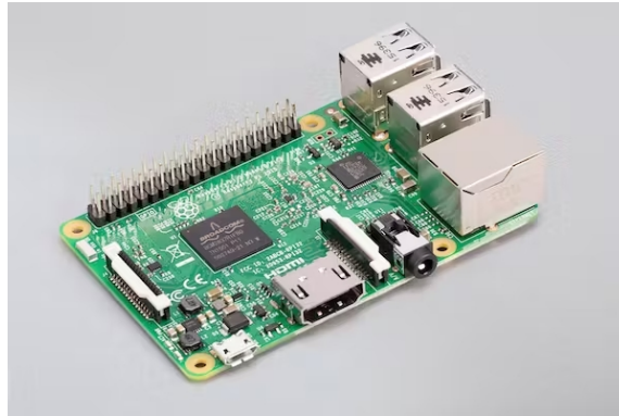
Slika 4.1 Raspberry Pi 3 Model B[5]
