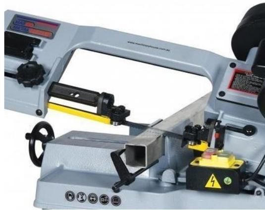
Slika 52. Tračna pila za rezanje profila [24]
