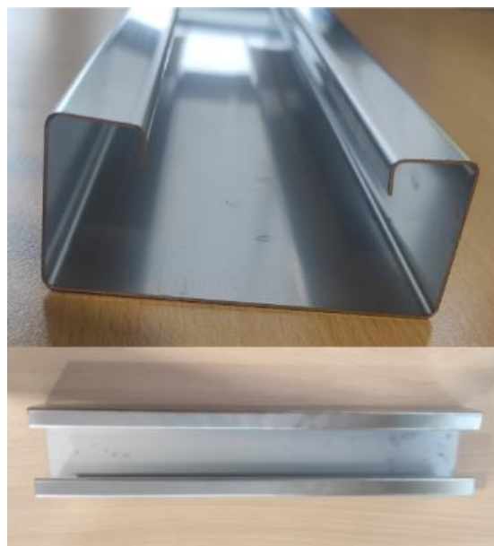
Slika 51. Profil (prečka) [izvor: autorica]
