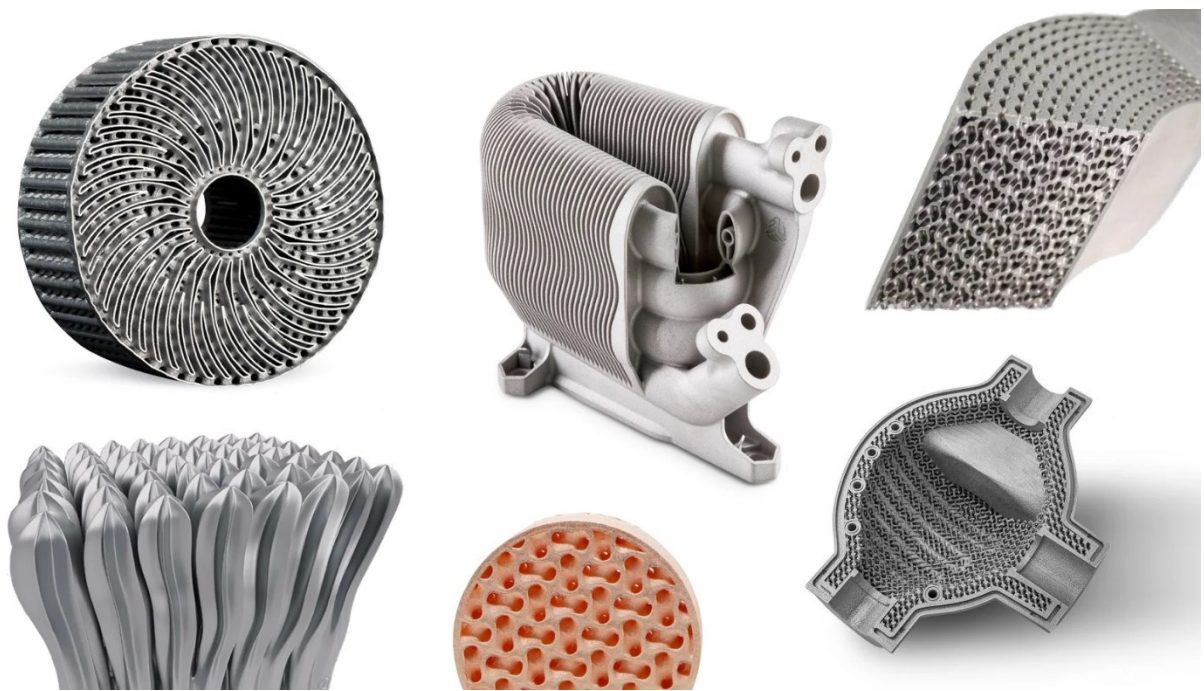
Slika 2.2. Poboljšani izmjenjivači topline izrađeni aditivnim tehnologijama [3]
