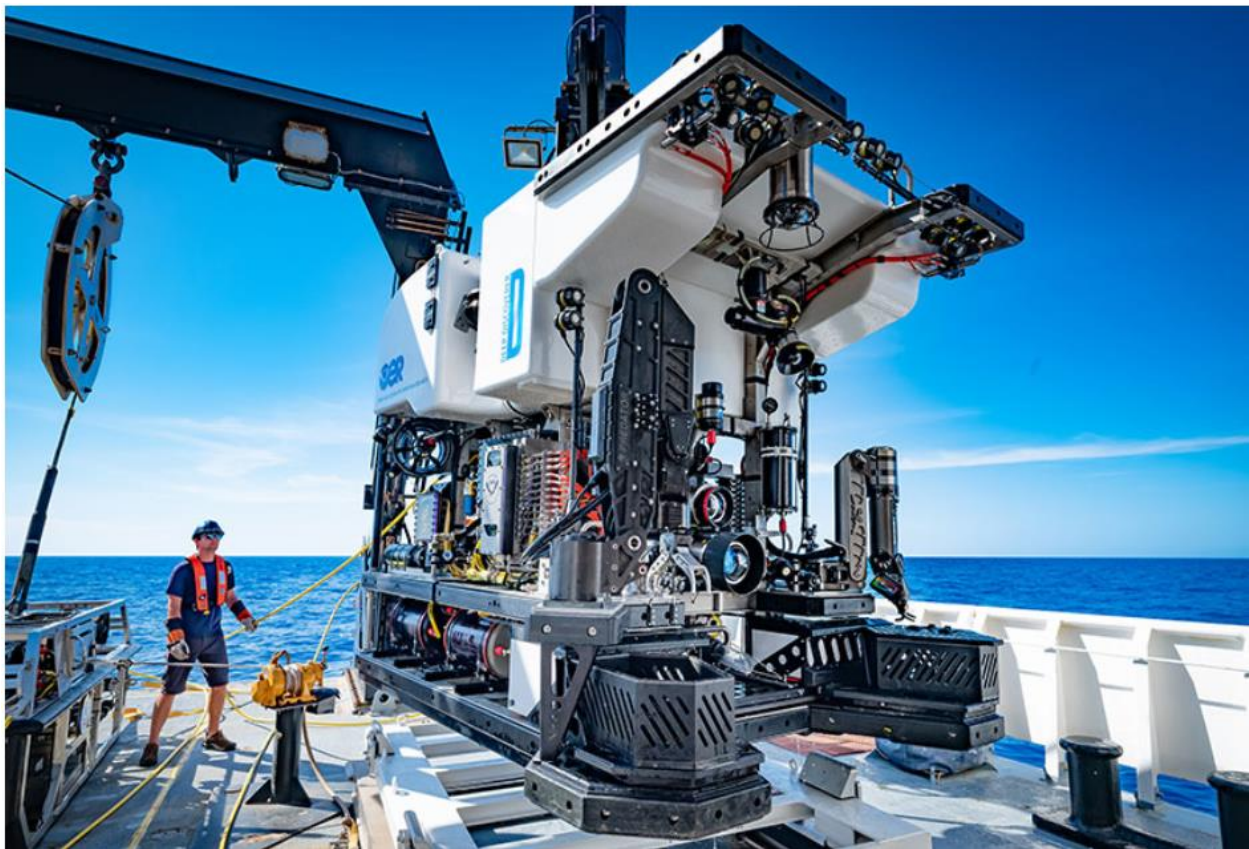
Slika 2-3. Daljinski upravljana ronilica, ROV (preuzeto iz [9])
