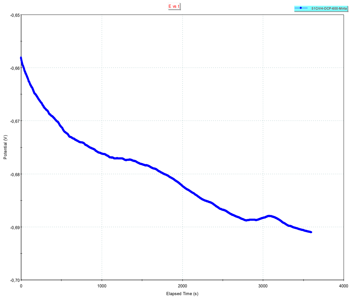
Slika 6.10. Dijagram potencijala otvorenog strujnog kruga u 3,5%-tnoj otopini NaCl
