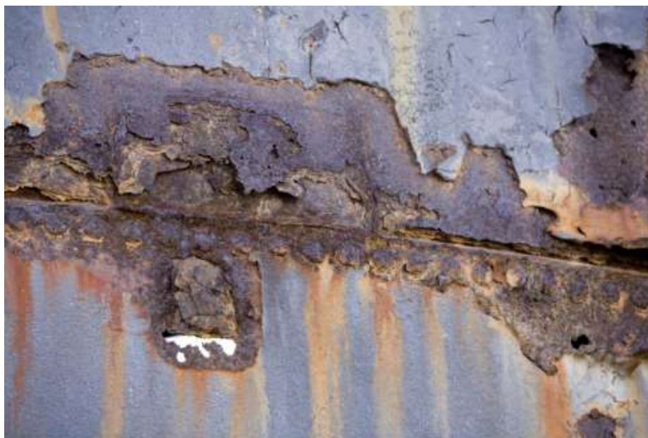
Slika 3.5. Primjer listanja metala [8]
