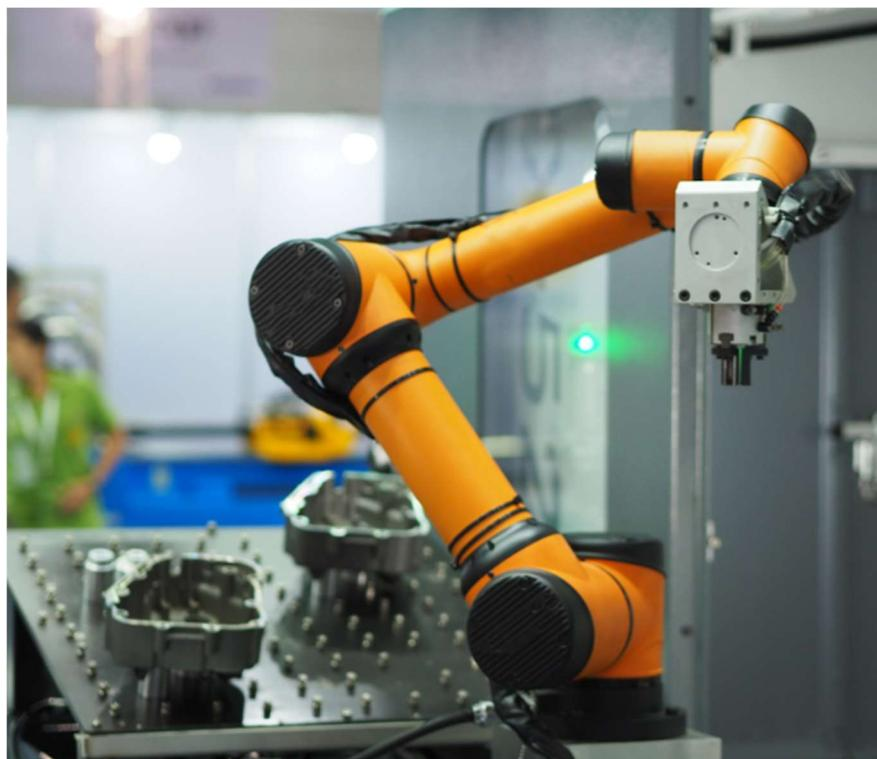
Slika 2.2 Primjer 6-osnog robota [2]
