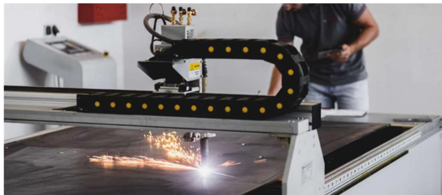
Slika 2.5 Primjer kartezijskog roboata [2]
