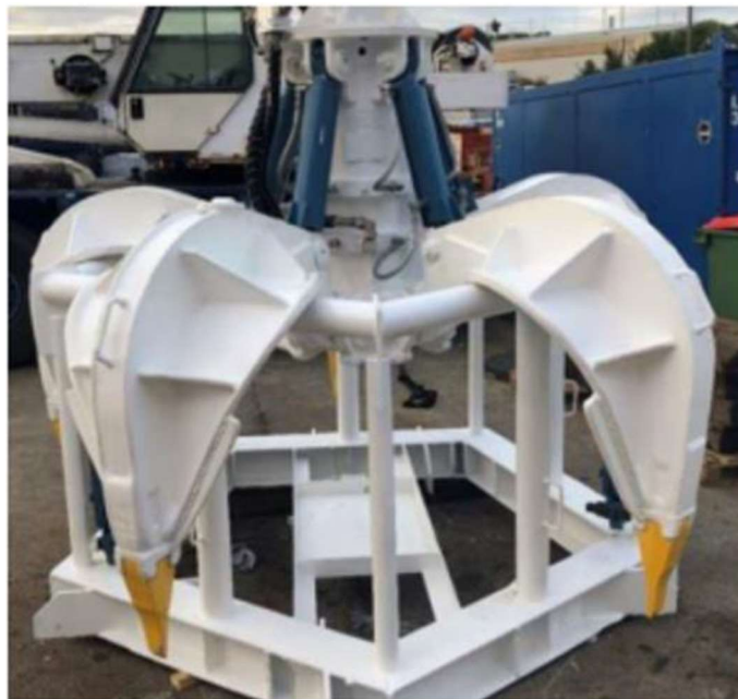
Slika 7.1: Primjer jedinice za grabljenje stijena [1]
