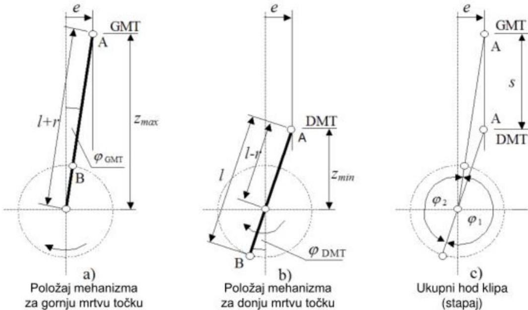
Slika 3.3 Krajni položaji klipa kod decentriranog koljenastog mehanizma [4]
