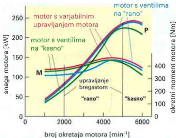
Slika 5.2 Karakteristike motora s varijabilnim upravljanjem ventila [7]
