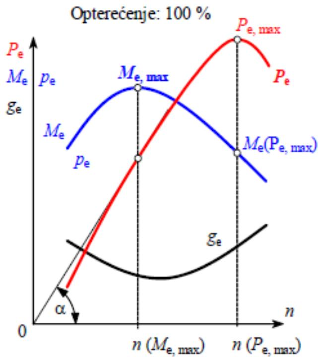
Slika 4.3.1 Značajke motora pri punom opterećenju [3]
