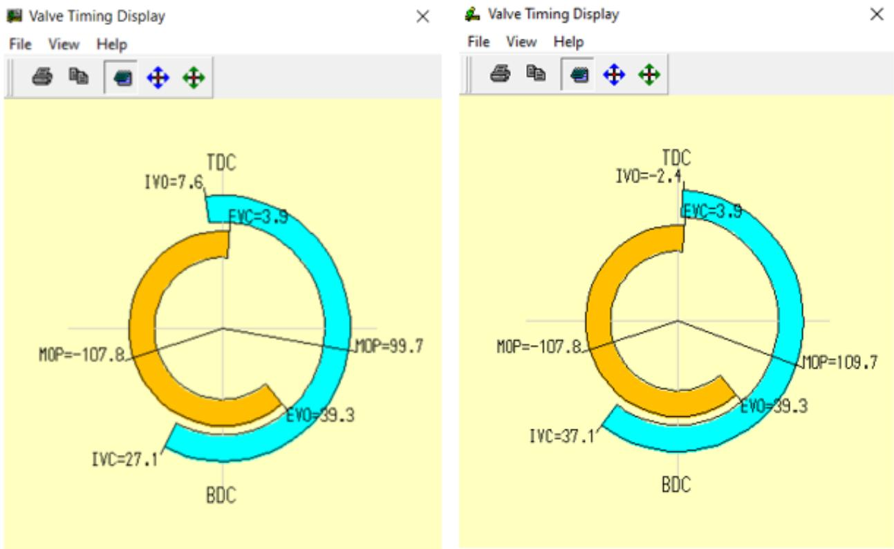
Slika 6.5.1 Kutovi otvaranja i zatvaranja usisnog ventila
