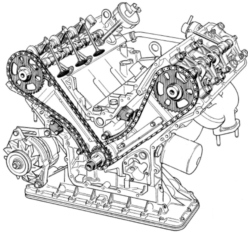
Slika 4.2 Razvodni mehanizam četverotaktnog V6 motora [6]
