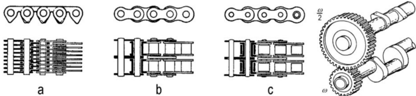
Slika 4.4 Zupčasti lanac (a), zglobni lanac s okretnim valjčićima (b), bez njih (c), zupčanici [6]
