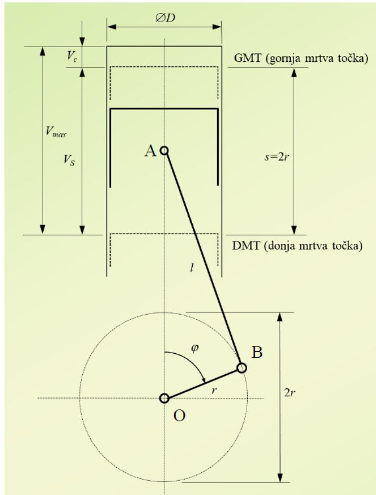
Slika 3.1 Osnovne geometrijske veličine klipnog mehanizma [4]
