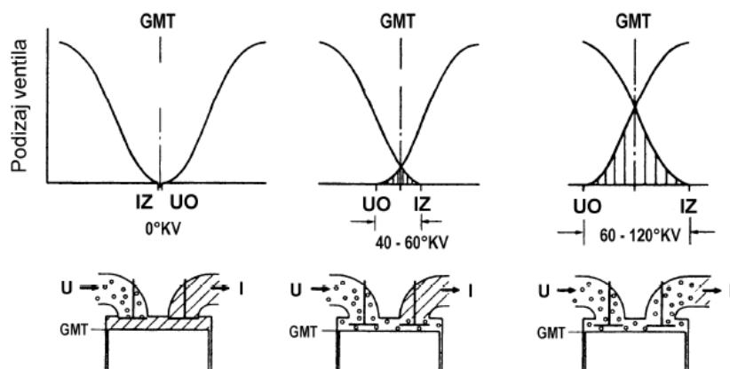
Slika 4.2.2 Preklapanje ventila [3]
