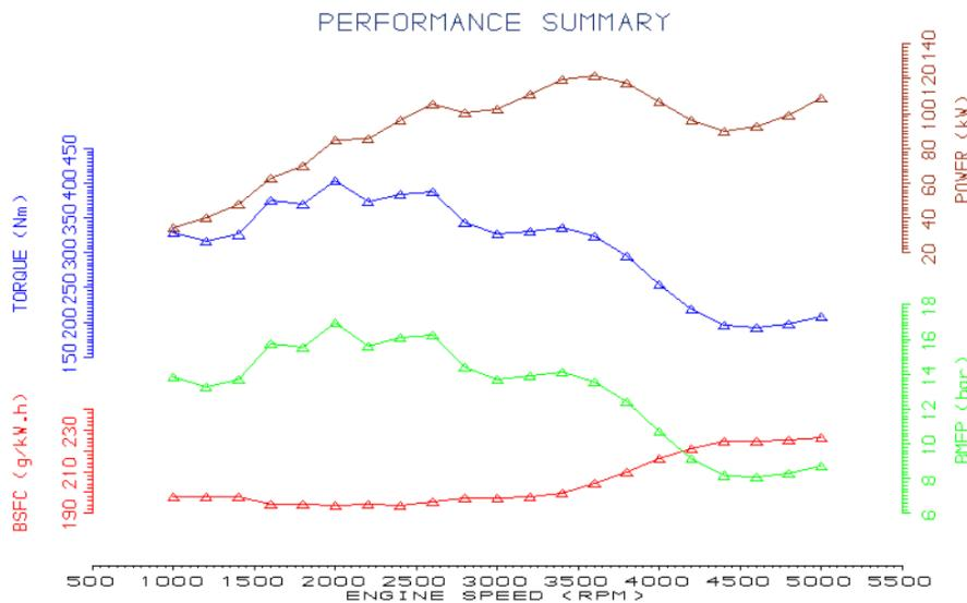
Slika 6.4.5 Osnovne značajke motora u ovisnosti o brzini vrtnje
