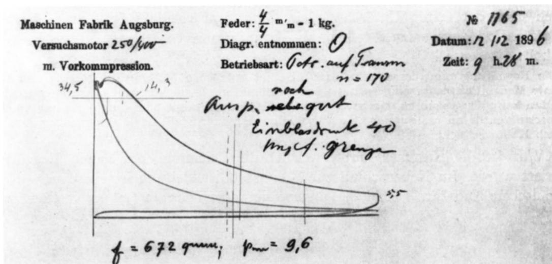
Slika 2.1.2 Indikatorski dijagram trećeg Dieselovog motora [4]
