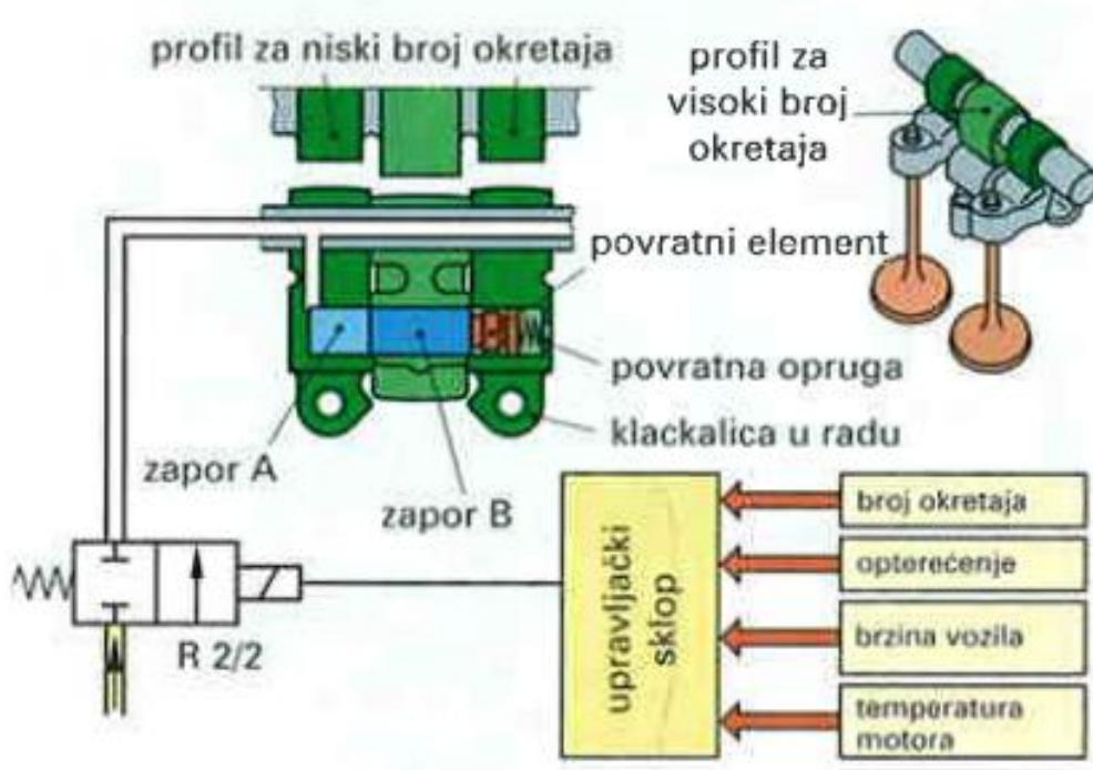
Slika 5.4 Variabilno podizanje ventila [7]
