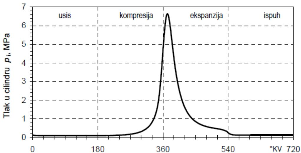
*Slika 2.2.4 Razvijeni indikatorski dijagram 4T motora [3]*
