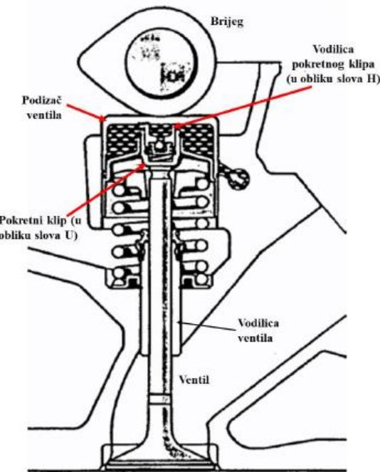
Slika 4.1.6 Hidraulički podizač [4]
