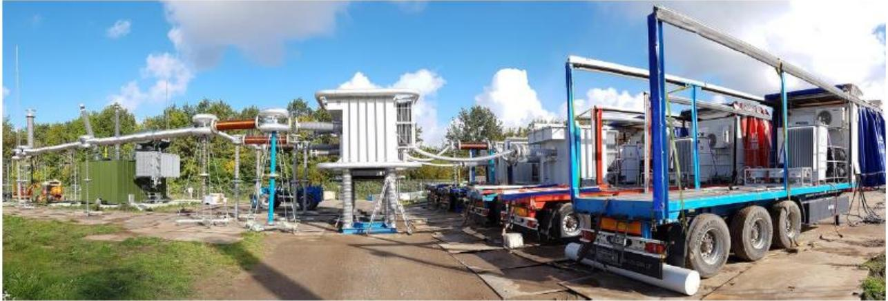
*Slika 6.1. Ispitni sustav za ispitivanje dugih AC 400kV kabela [10]*
