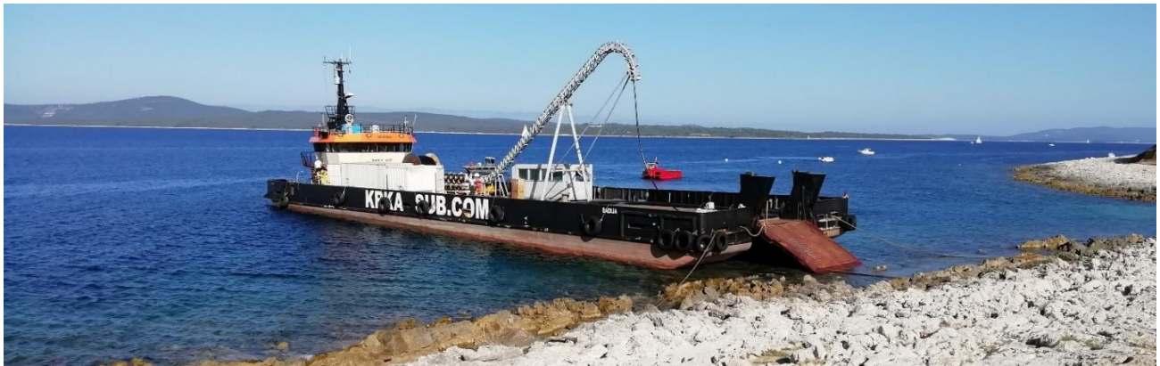
Slika 4.1. Brod za postavljanje podmorskog kabela koji se koristi u Hrvatskoj
