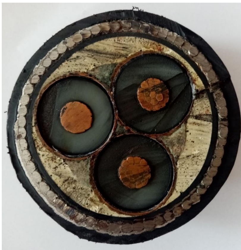
Slika 2.1. Presjek trožilnog podmorskog kabela
