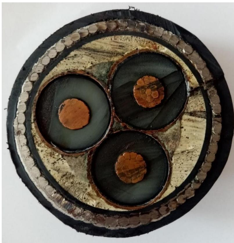
*Slika 2.1. Presjek trožilnog podmorskog kabela*
