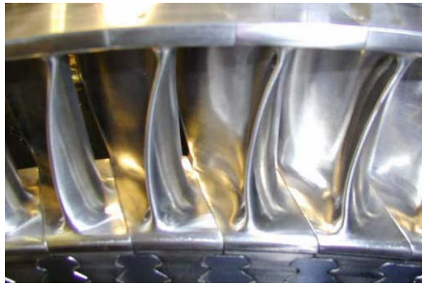
Slika 3.6. Rotorska lopatica zakrivljenog profila [7]
