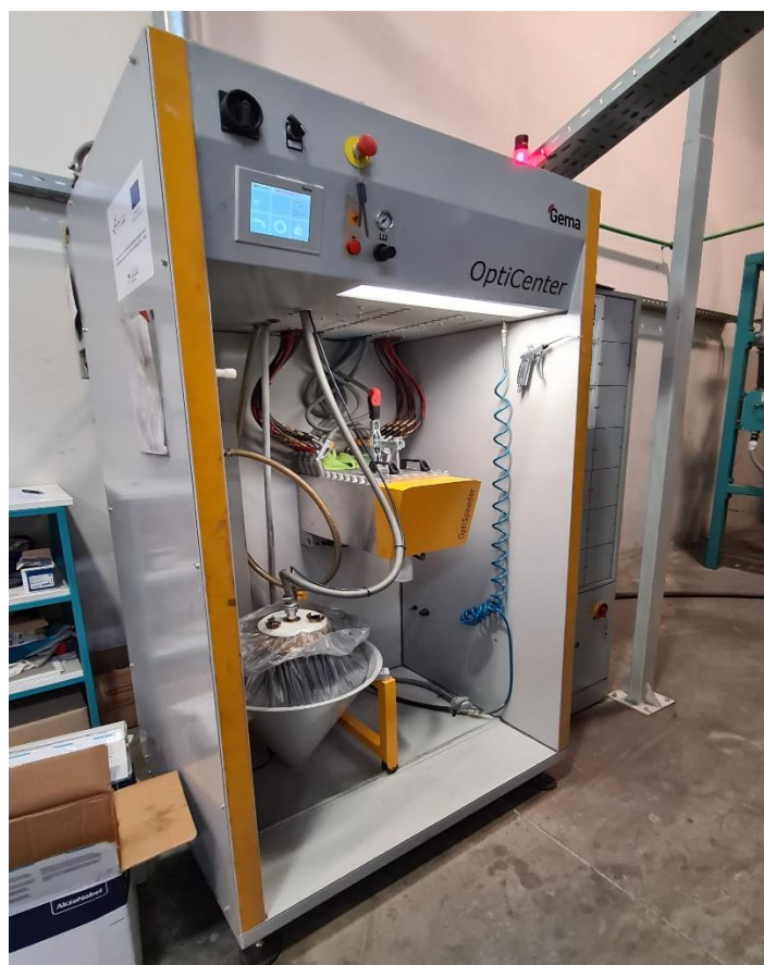
Slika 6.15. Centar za upravljanje prahom u Alpronu
