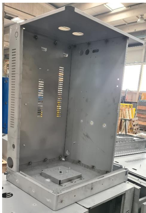
Slika 3.15. Montaža pozicija u sklop zavarivanjem
