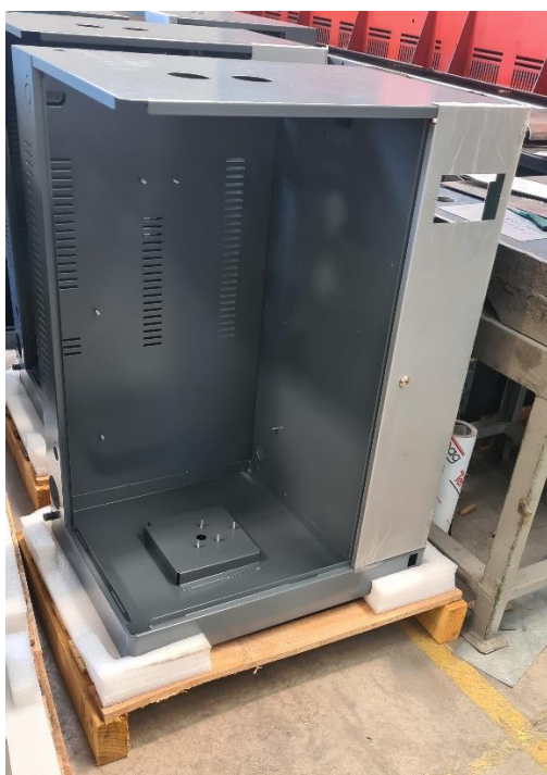
Slika 3.16. Sklop kućišta nakon elektrostatskog praškastog farbanja
