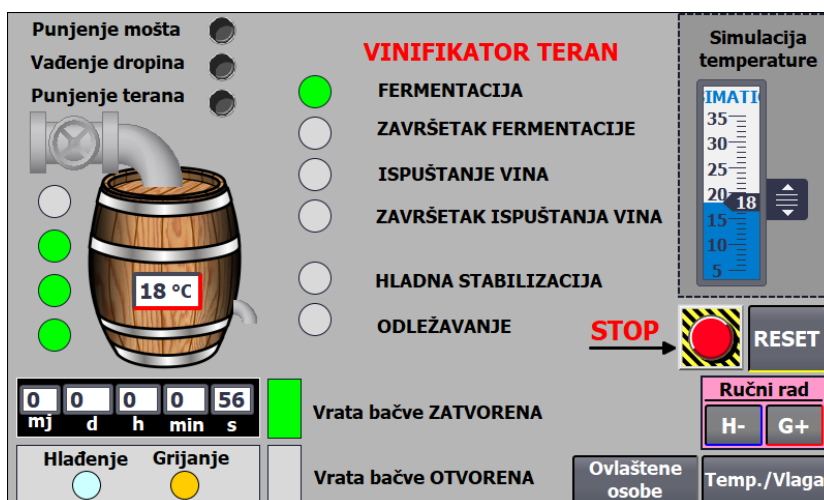
Slika 8.12 Prikaz zaslona Vinifikator teran bačva (primjer 1).
