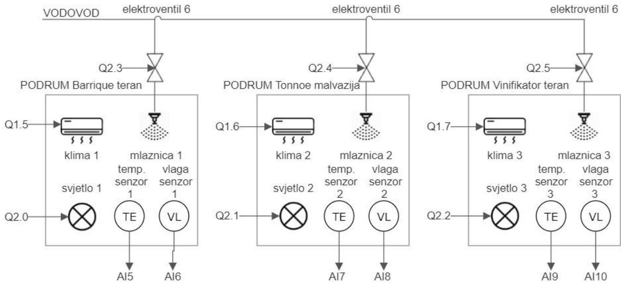
Slika 5.3 Shema temperature, vlage i rasvjete podruma.
