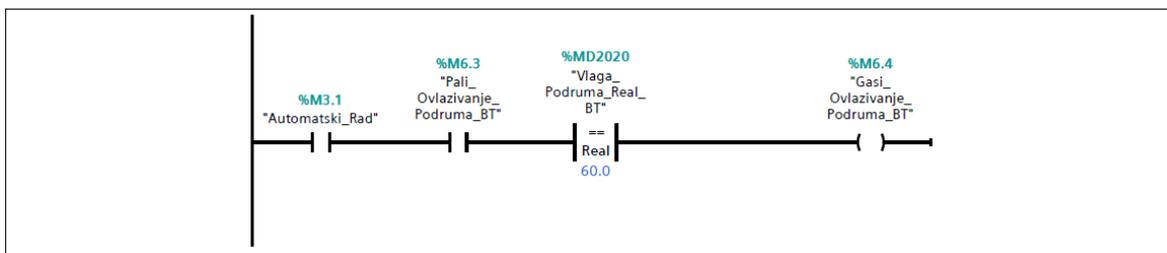
Slika 7.7 03\_Temperatura i vlaga podruma BT [FC4]
