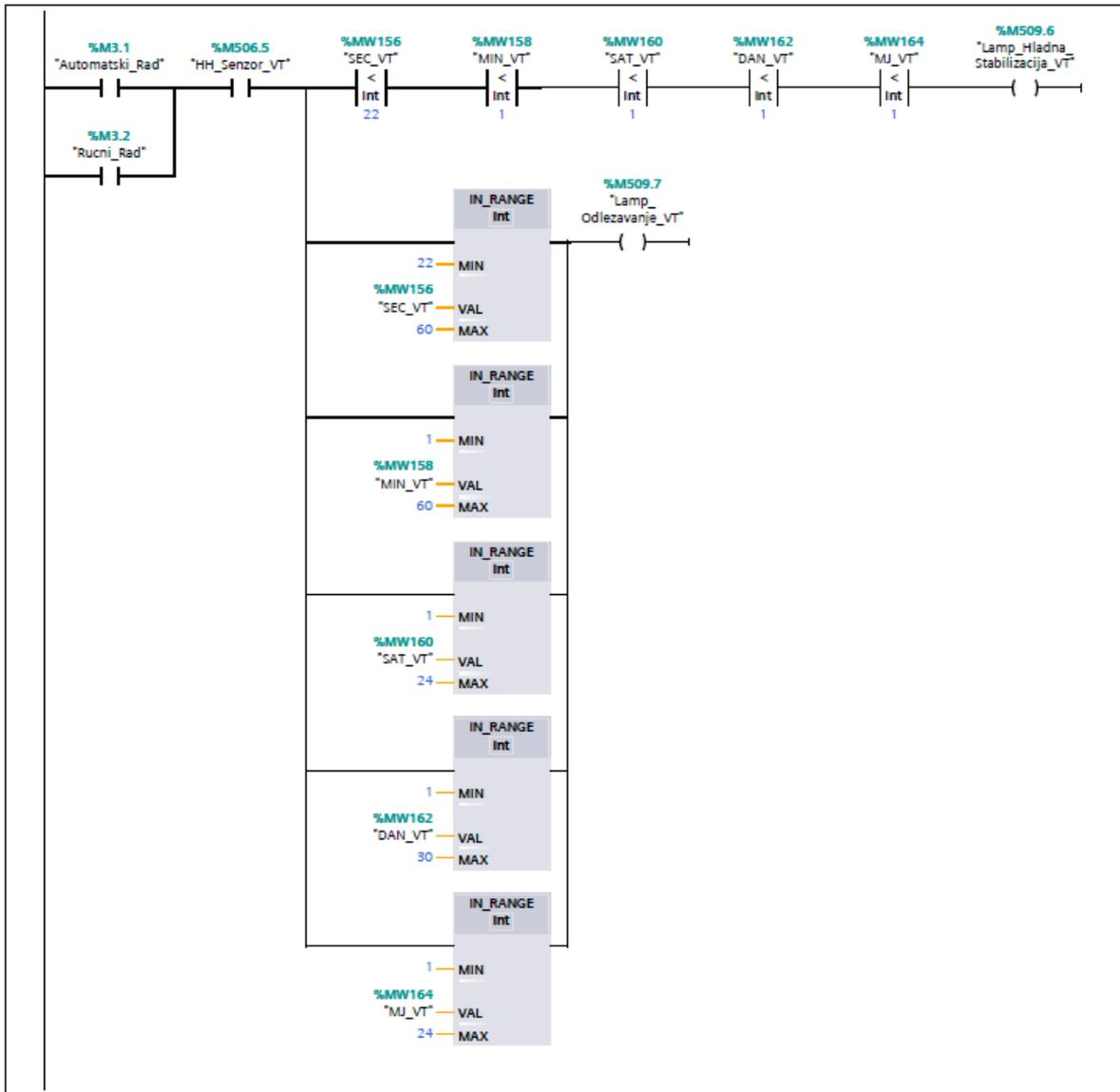
Slika 7.13 12\_Temperatura vinifikatora [FC13]
