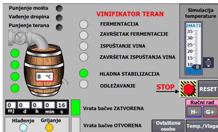
Slika 8.15 Prikaz zaslona Vinifikator teran bačva (primjer 4).
