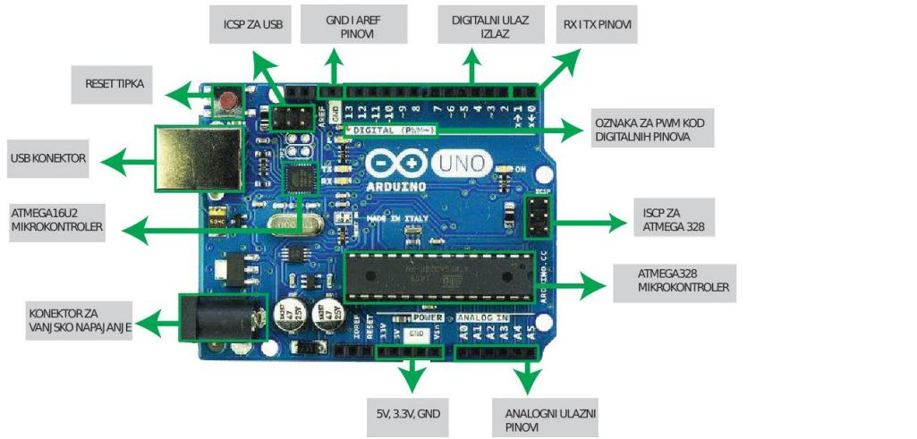
Slika 2.1 Prikaz Arduino UNO pločice s naznačenim dijelovima
