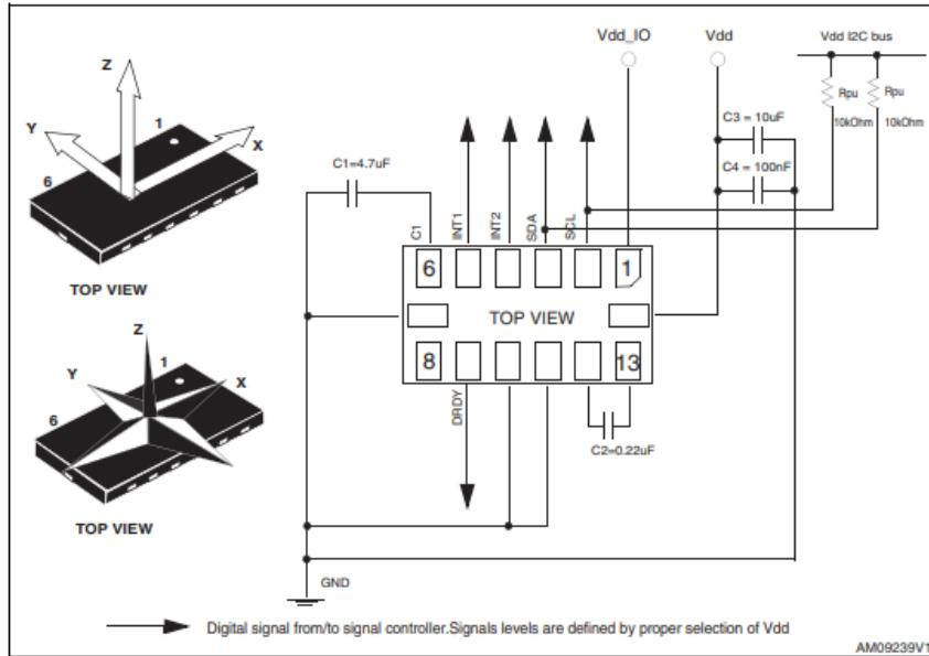
Slika 3.2 Tipična shema spajanja magnetometra
