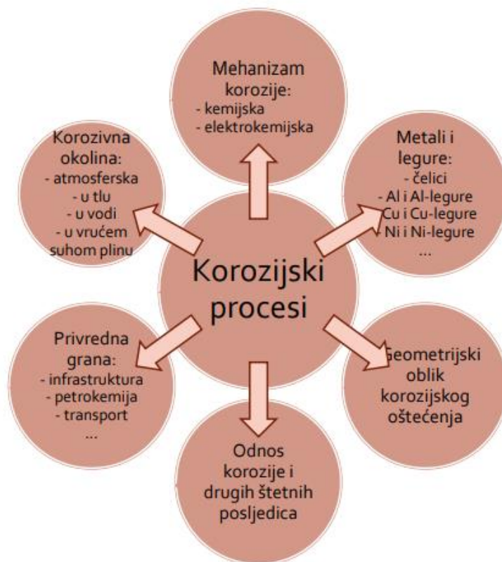
Slika 2.3 Klasifikacija korozijskih procesa [2]
