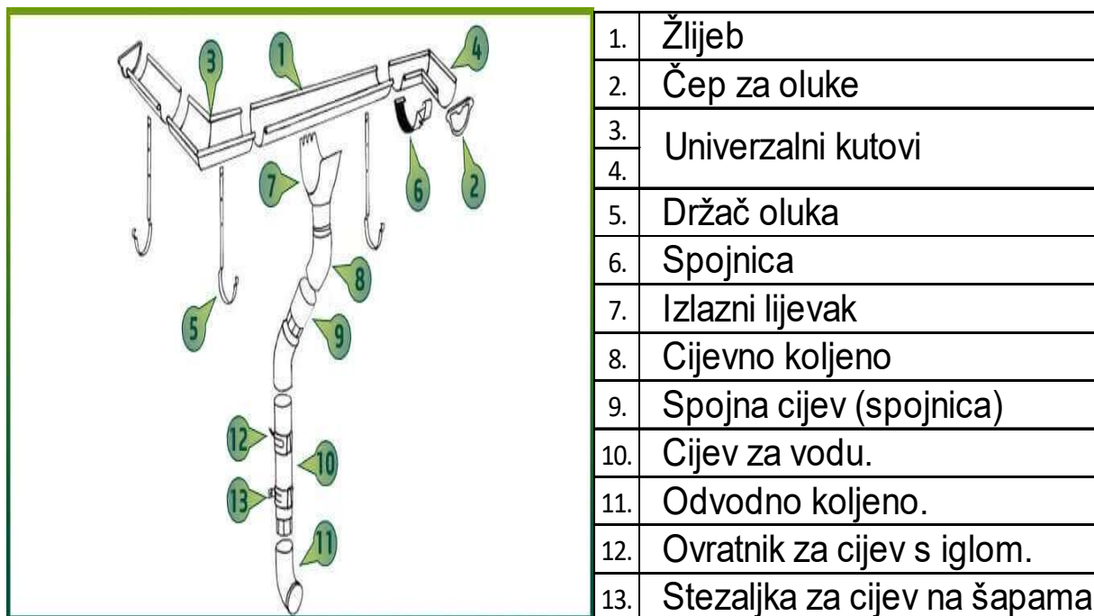
Slika 3.5. Raščlanjeni sustav dovodnih cijevi [10]
