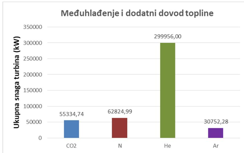
Slika 6.39. Uкупne snage turbinu u zatvorenom sustavu s međuhladnjakom i dodatnim izmjenjivačem topline
