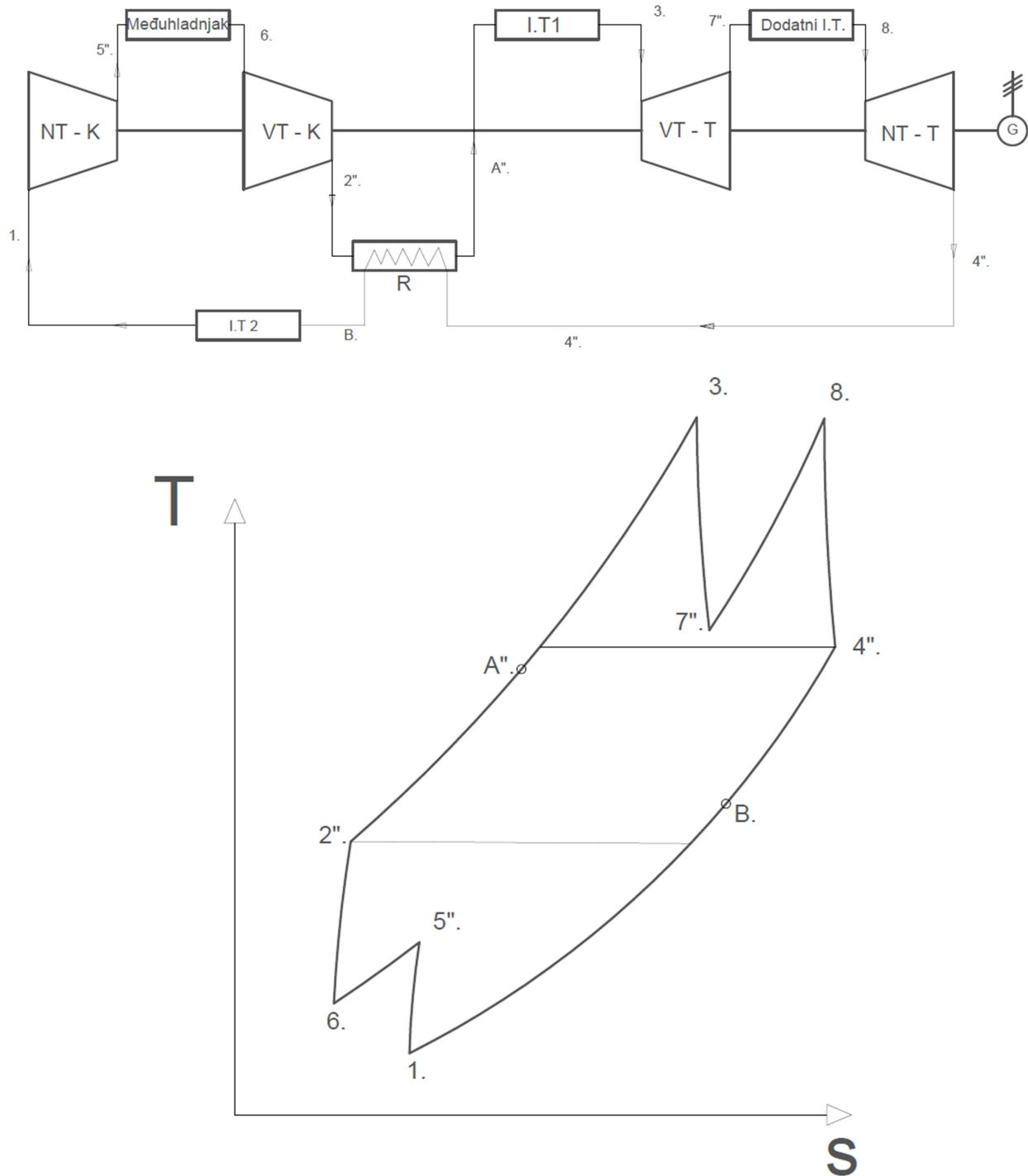
Slika 5.8. Shema i T-s dijagram zatvorenog sustava sa međuhladnjakom, dodatnim izmjenjivačem topline i regeneratorom
