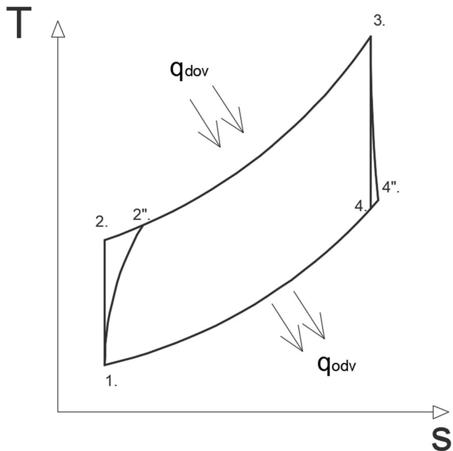
Slika 5.1 T-s dijagram i shema osnovnog zatvorenog sustava
