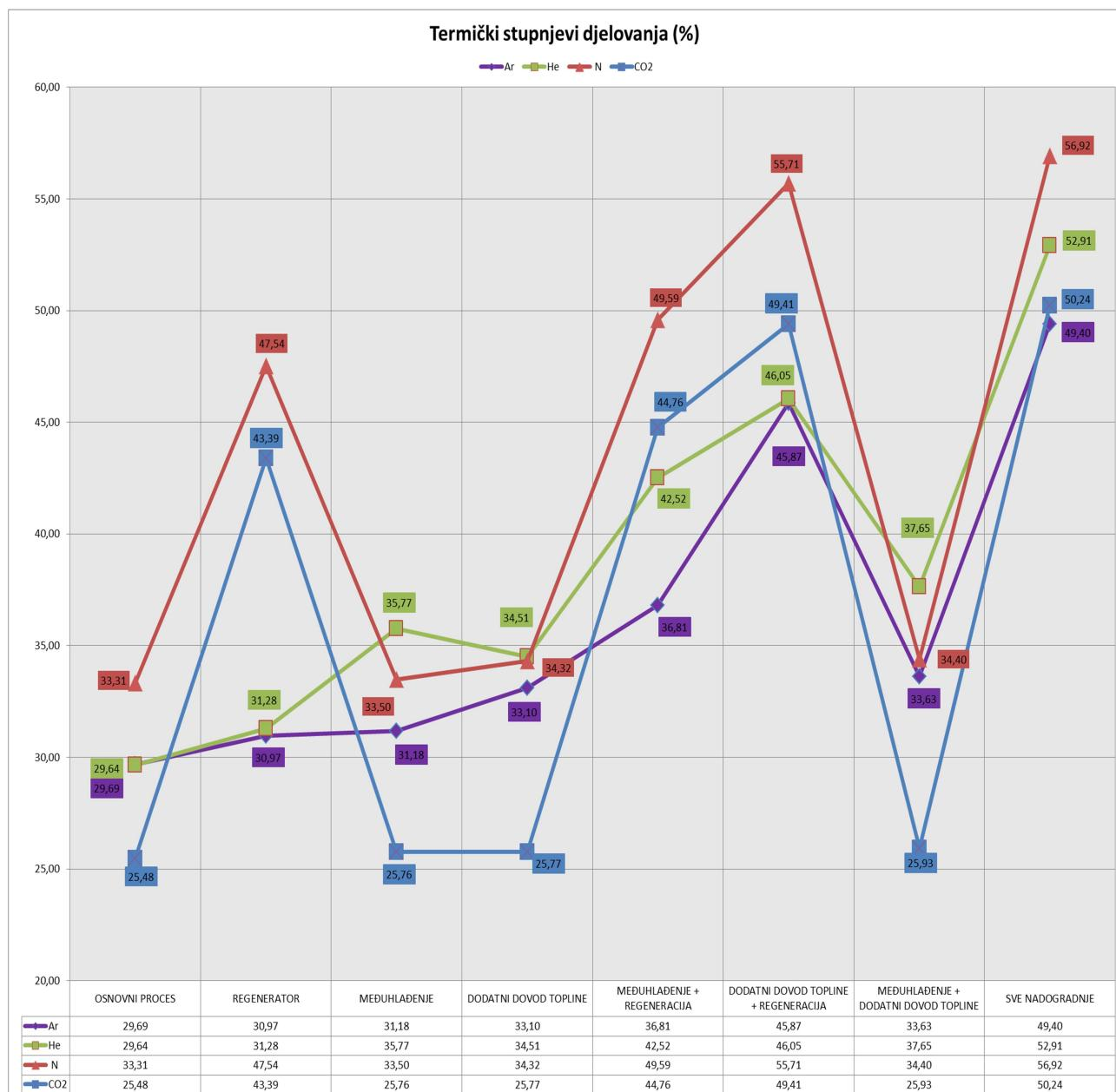
*Slika 7.6. Termički stupnjevi djelovanja zatvorenog plinskoturbinskog postrojenja sa svim nadogradnjama te različitim radnim medijima*
