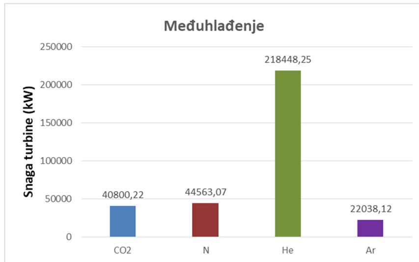
Slika 6.19. Snage turbine zatvorenog sustava s međuhladnjakom
