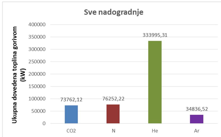
Slika 6.46. Ukupno dovedena toplina gorivom u zatvorenom sustavu s dodatnim izmjenjivačem topline, međuhladnjakom i regeneratorom
