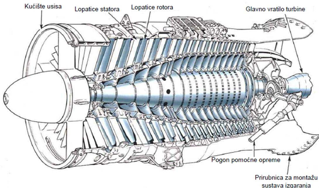
Slika 2.4 Aksijalni kompresor s jednim vratilom rotora
