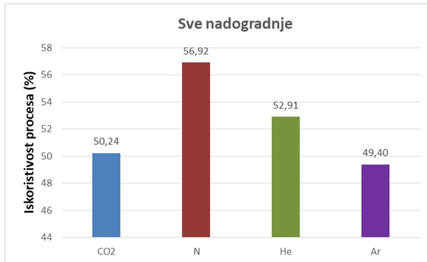
Slika 6.47. Termički stupanj iskoristivosti za zatvoreni sustav s dodatnim izmjenjivačem topline, međuhladnjakom i regeneratorom
