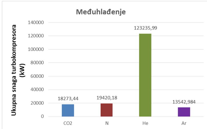
Slika 6.18. Ukupne snage turbokompresora zatvorenog sustava s međuhladnjakom
