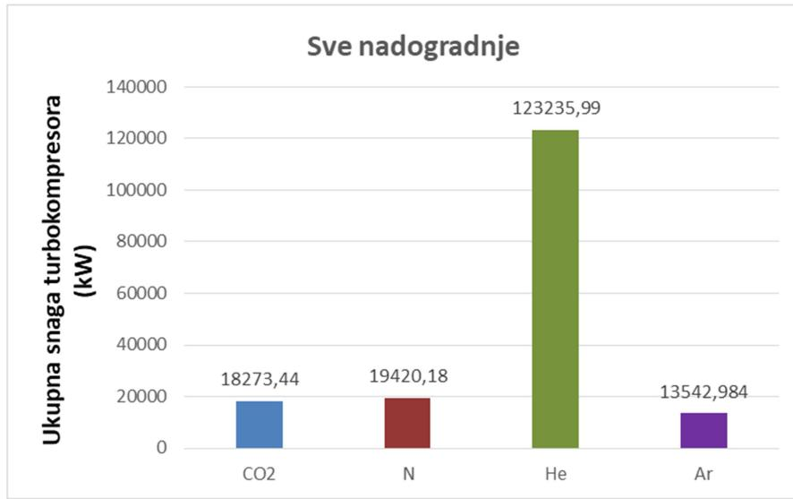
Slika 6.43. Ukupne snage turbokompresora za zatvoreni sustav s međuhladnjakom, dodatnim izmenjivačem topline i regeneratorom
