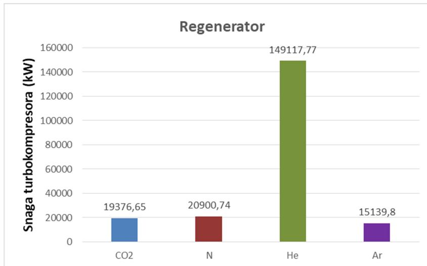
Slika 6.14. Snage turbokompresora zatvorenog sustava s regeneratorom
