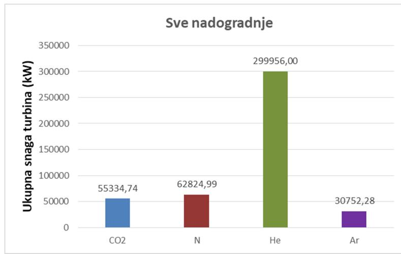
*Slika 6.44. Ukupna snaga turbine u zatvorenom sustavu s međuhladnjakom, dodatnim izmenjivačem topline i regeneratorom*
