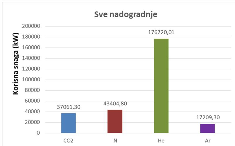
*Slika 6.45. Korisna snaga zatvorenog sustava s međuhladnjakom, dodatnim izmenjivačem topline i regeneratorom*
