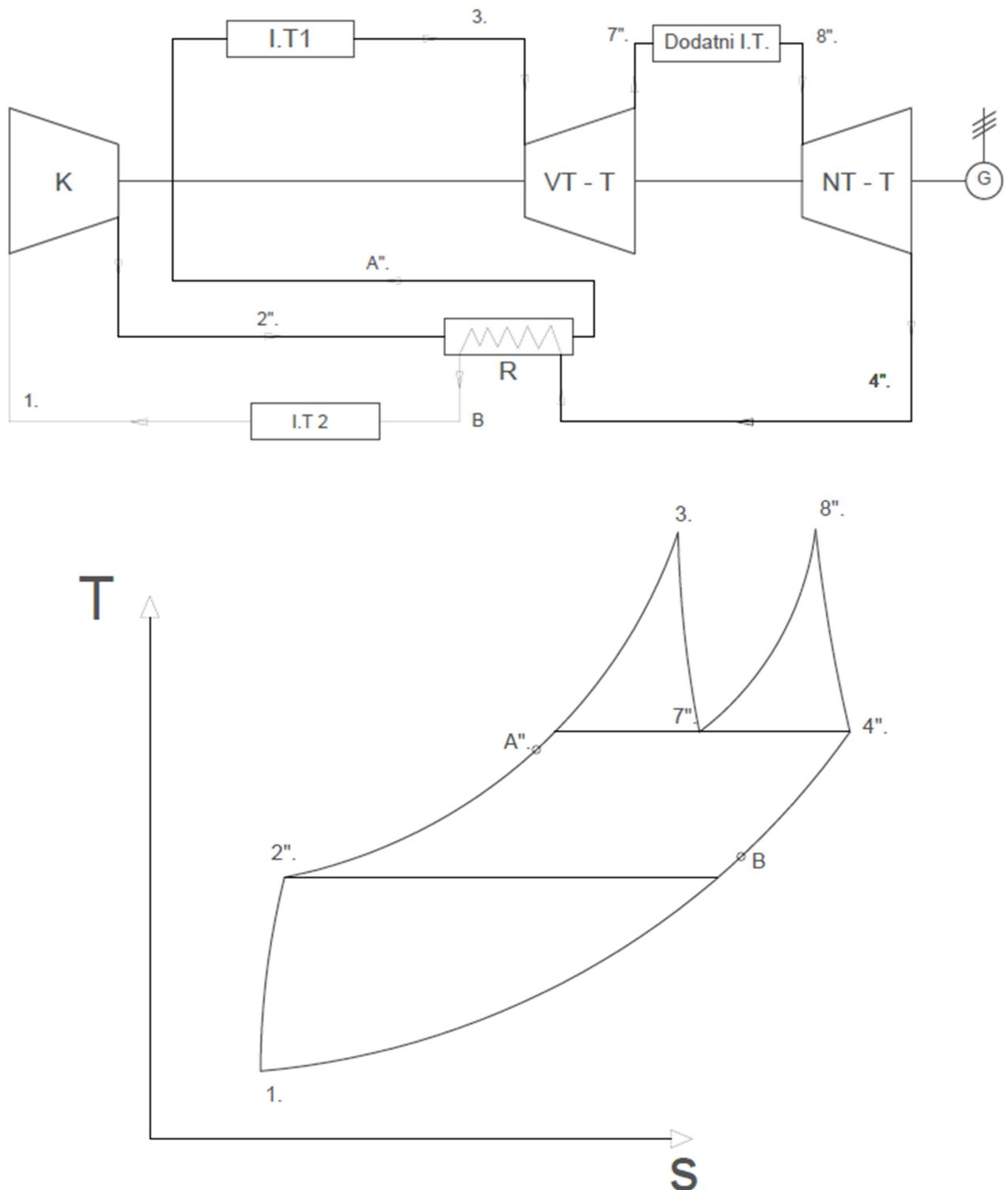
Slika 5.6. Shema i T-s dijagram zatvorenog sustava s dodatnim izmjenjivačem topline i regeneratorom
