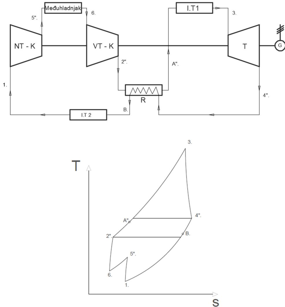
Slika 5.5. Shema i T-s dijagram zatvorenog sustava s međuhladnjakom i regeneratorom
