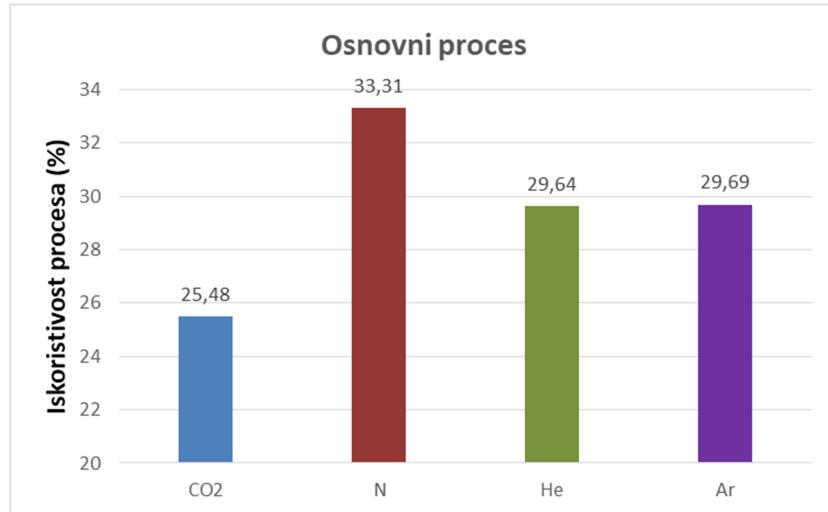
*Slika 6.12. Stupnjevi iskoristivosti za osnovni proces u zatvorenom sustavu*
