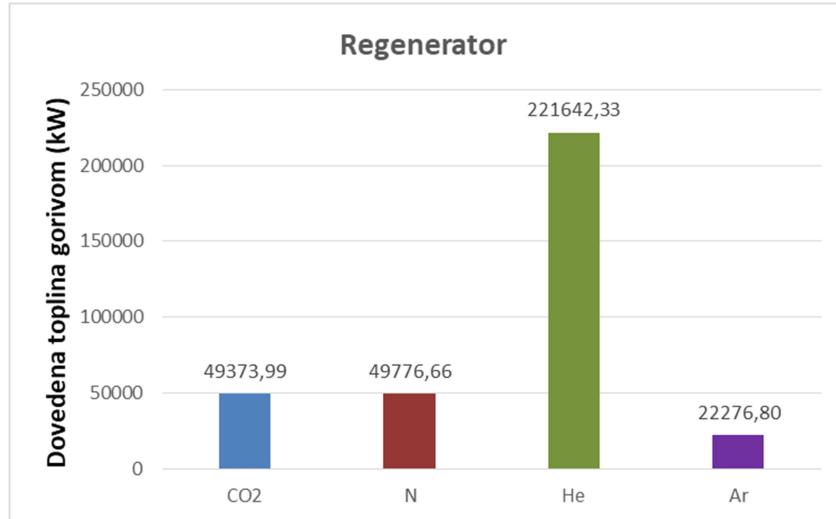
Slika 6.16. Dovedena toplina gorivom u zatvorenom sustavu s regeneratorom
