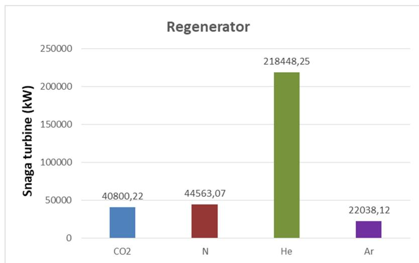
Slika 6.13. Snage turbine zatvorenog sustava s regeneratorom
