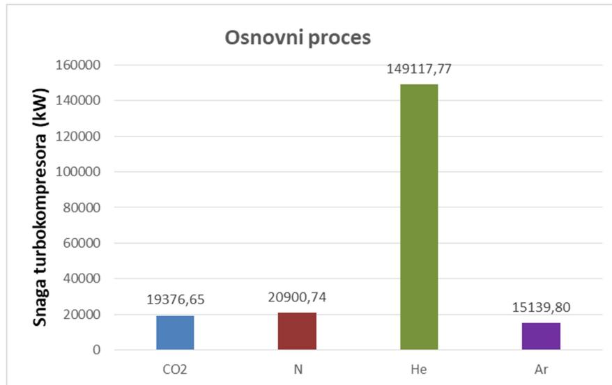
*Slika 6.9. Snage kompresora osnovnog procesa u zatvorenom sustavu*
