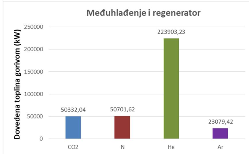
Slika 6.29. Dovedena toplina u zatvoreni sustav s međuhladnjakom i regeneratorom
