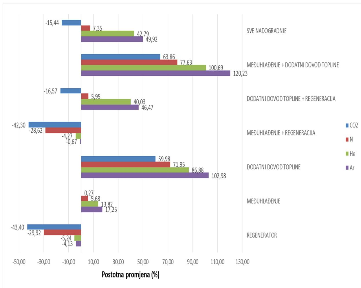
Slika 7.4. Promjena ukupne dovedene topline gorivom u odnosu osnovn proces
