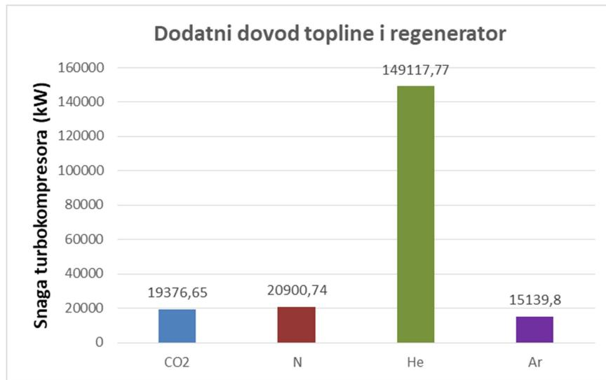
Slika 6.33. Snage turbokompresora zatvorenog sustava s dodatnim izmjenjivačem topline i regeneratorom
