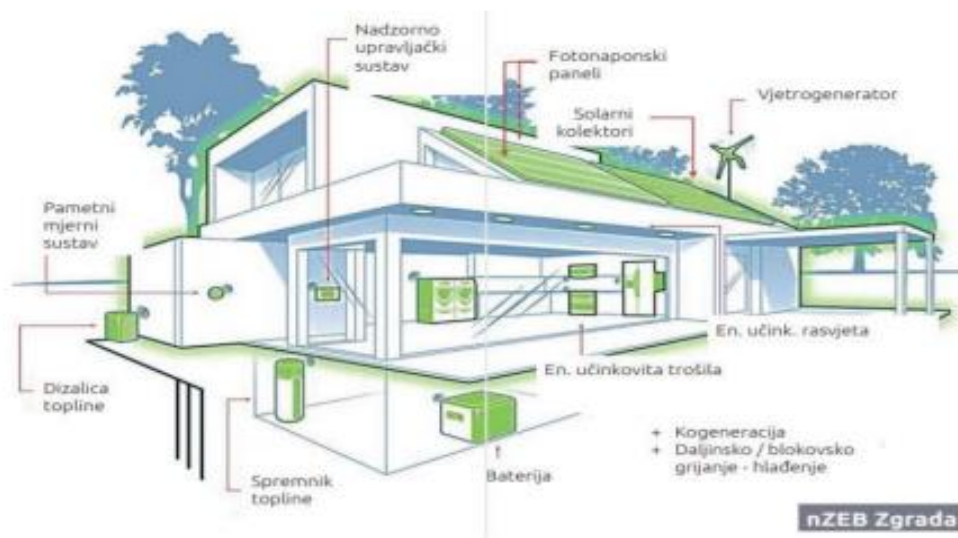
Slika 2.1 – Primjer nZEB zgrade [9]
