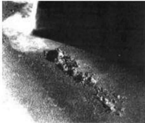
Slika 2.27.: Oštećenje lopatice turbine kavitacijskom korozijom [3]
