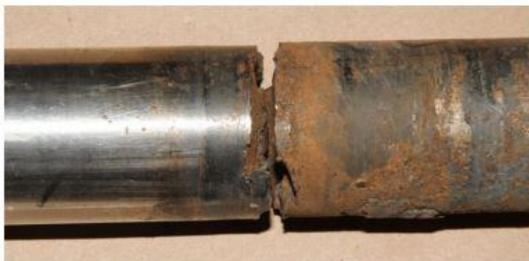
Slika 2.24.: Lom vratila uslijed korozijskog zamora [3]
