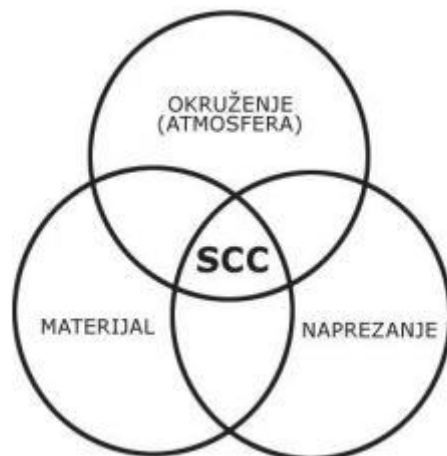
Slika 2.23.: Čimbenici koji utječu na pojavu napetosne korozije [12]
