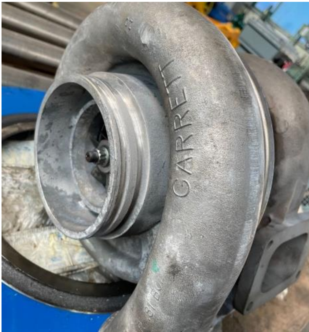
Slika 6.7 Turbopuhalo motora Waukesha H24GL [autor]
