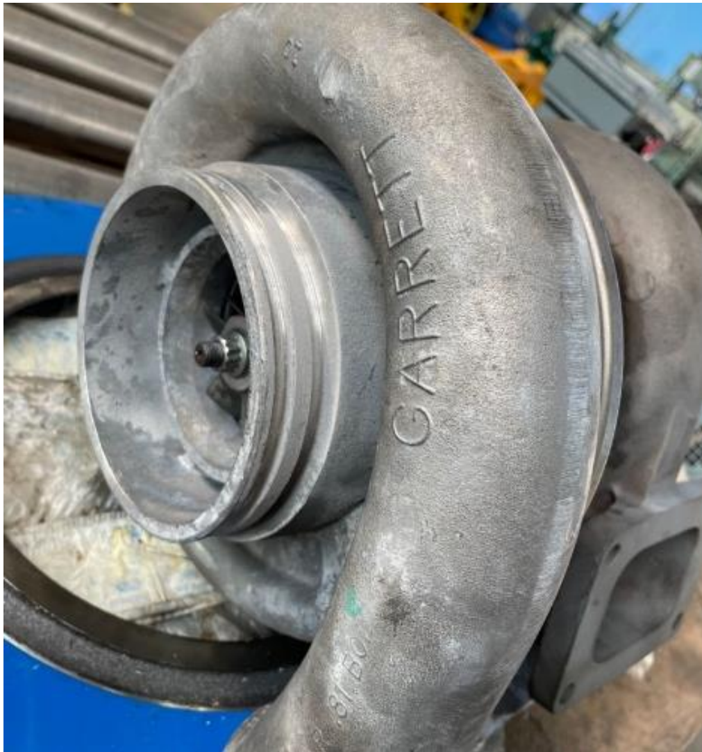
Slika 6.7 Turbopuhalo motora Waukesha H24GL [autor]
